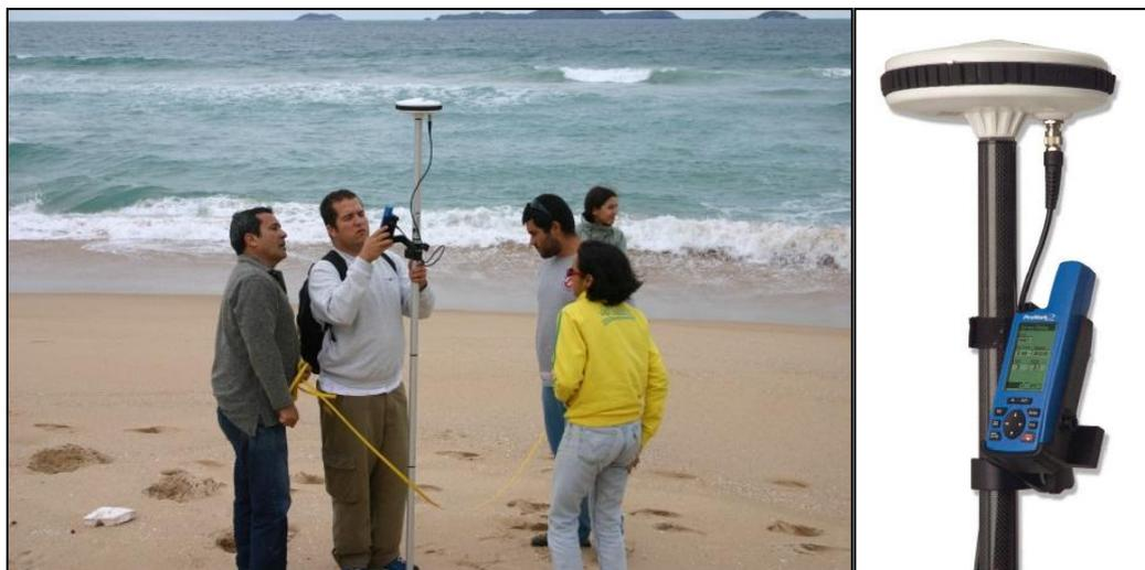
Fig. 10 - Equipe do LAGECOST trabalhando com o *DGPS Pro Mark 2.0*, em destaque à direita. Foto: Castro, J.W.A.
