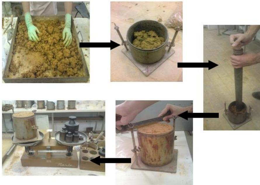
**Fig.5: Sequência de fotos que mostra as etapas do ensaio de compactação: mistura do solo com água, colocação sucessiva das camadas de solo no cilindro seguido pelos golpes com o soquete, preparação do cilindro para pesagem e pesagem.**
