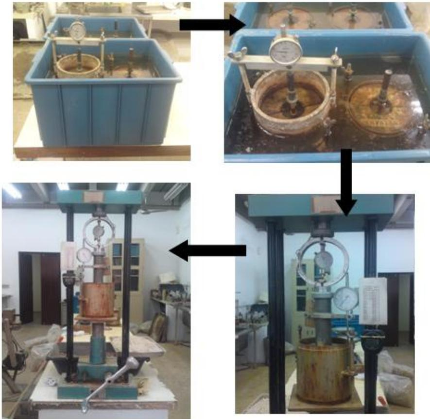
**fig.6: Submersão dos corpos de prova, e prensa controlada manualmente para o ensaio CBR.**
