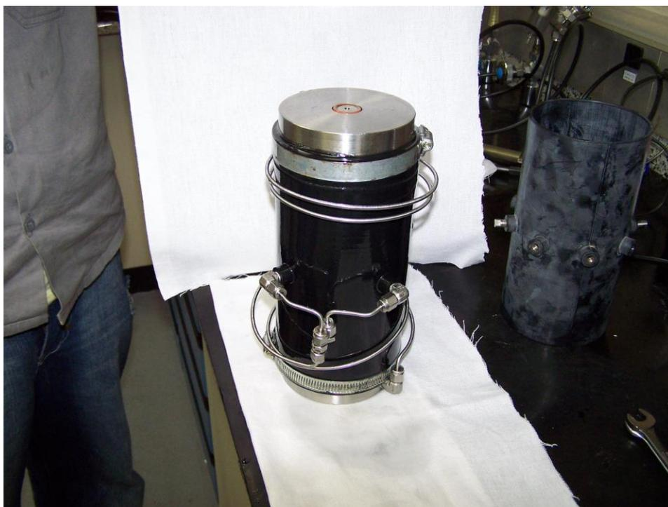
**Figura 4: Amostra colocada na membrana e pronta para teste.**
