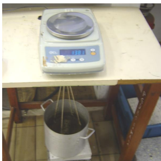
Figura 15: Determinação da massa submersa através de dispositivo acoplado no fundo da balança.
