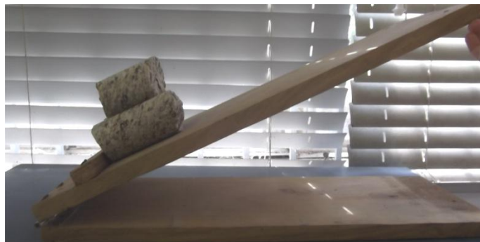
Figura 14: Medida do ângulo de atrito básico através do ensaio de Tilt Test .
