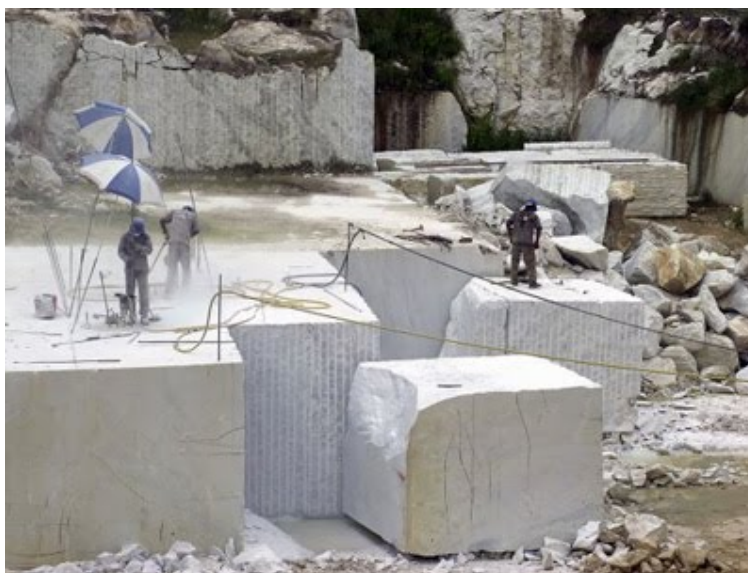
Figura 2 – Foto de uma exploração em blocos de jazida de rocha ornamental. Imagem extraída de: http://pensarecriar2010.blogspot.com/2010/05/1-pergunta-o-que-sao-rochas-ornamentais.html acessado em novembro de 2011.
