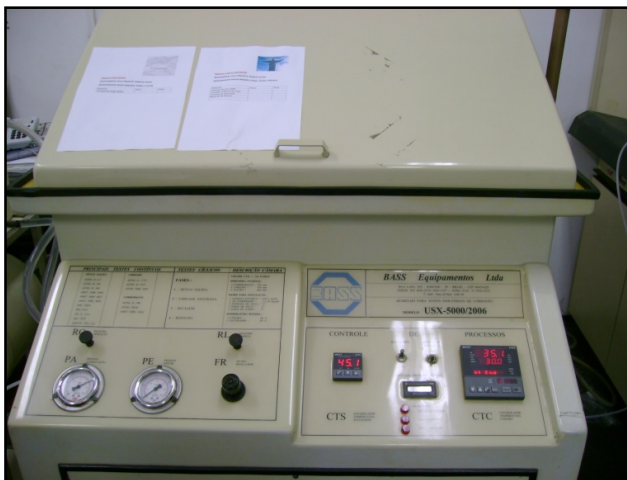
Figura 12 – Fotografia de câmara utilizada para ensaio de exposição à névoa salina.
