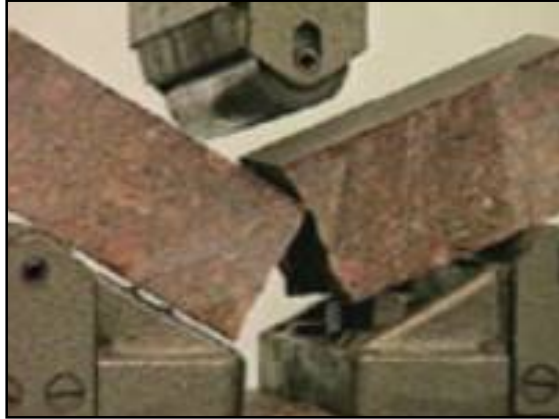
Figura 8 - Foto que exemplifica a resposta de amostra fraturada pelo ensaio de flexão. Retirada de Frascá, 2001.
