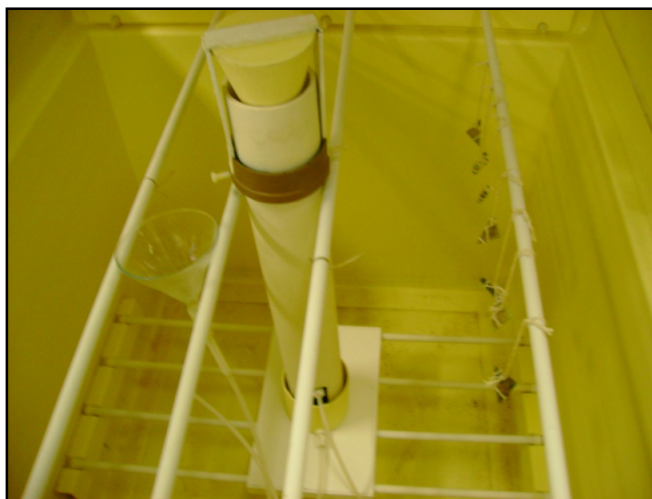
Figura 13 – Fotografia do interior de uma câmara de ensaio de névoa salina.
