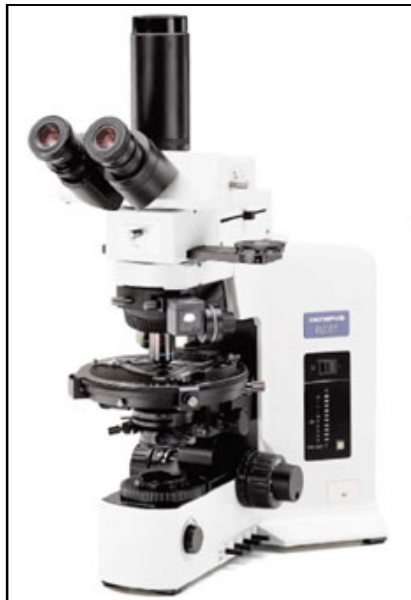
Figura 6 – Fotografia de um modelo de microscópio petrográfico. Extraído de: http://www.nitsac.com/web/index.php?cPath=30_67 acessado em novembro de 2011.
