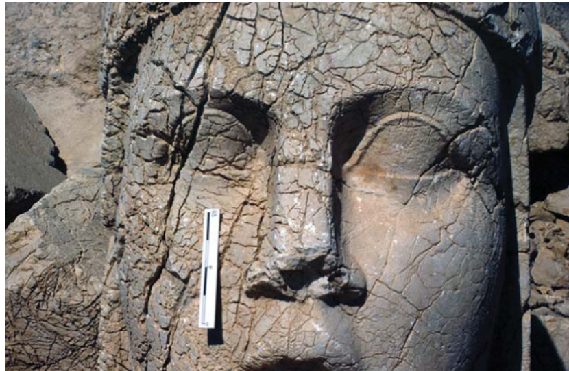
Figura 18 - Fotografia que exemplifica a formação de rachaduras em escultura de argila. Imagem retirada de: Illustrated Glossary on Stone Deterioration Patterns , ICOMOS, 2008, p.35.
