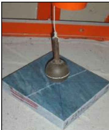
Figura 9 - Fotografia que representa um exemplo de amostra de rocha quando submetida ao impacto de corpo duro. Retirado de Frascá (2001).
