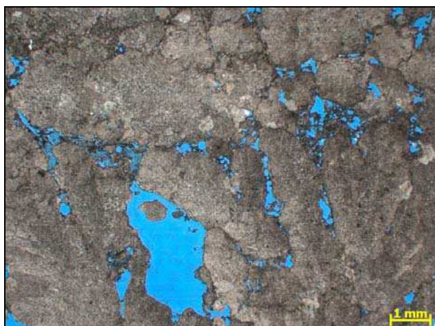
Figura 29 - Vista geral dos carbonatos com estruturas arborescentes. Observar porosidade em azul (Lâmina retirada do plugue C1).
