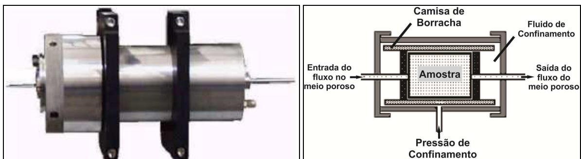
Figura 25 – Visões externa (esquerda) e interna (direita) de um exemplo de holder hidroestático. Os fluidos de confinamento mais utilizados são água e óleo (Modificada de VIEIRA et al. , 2010).
