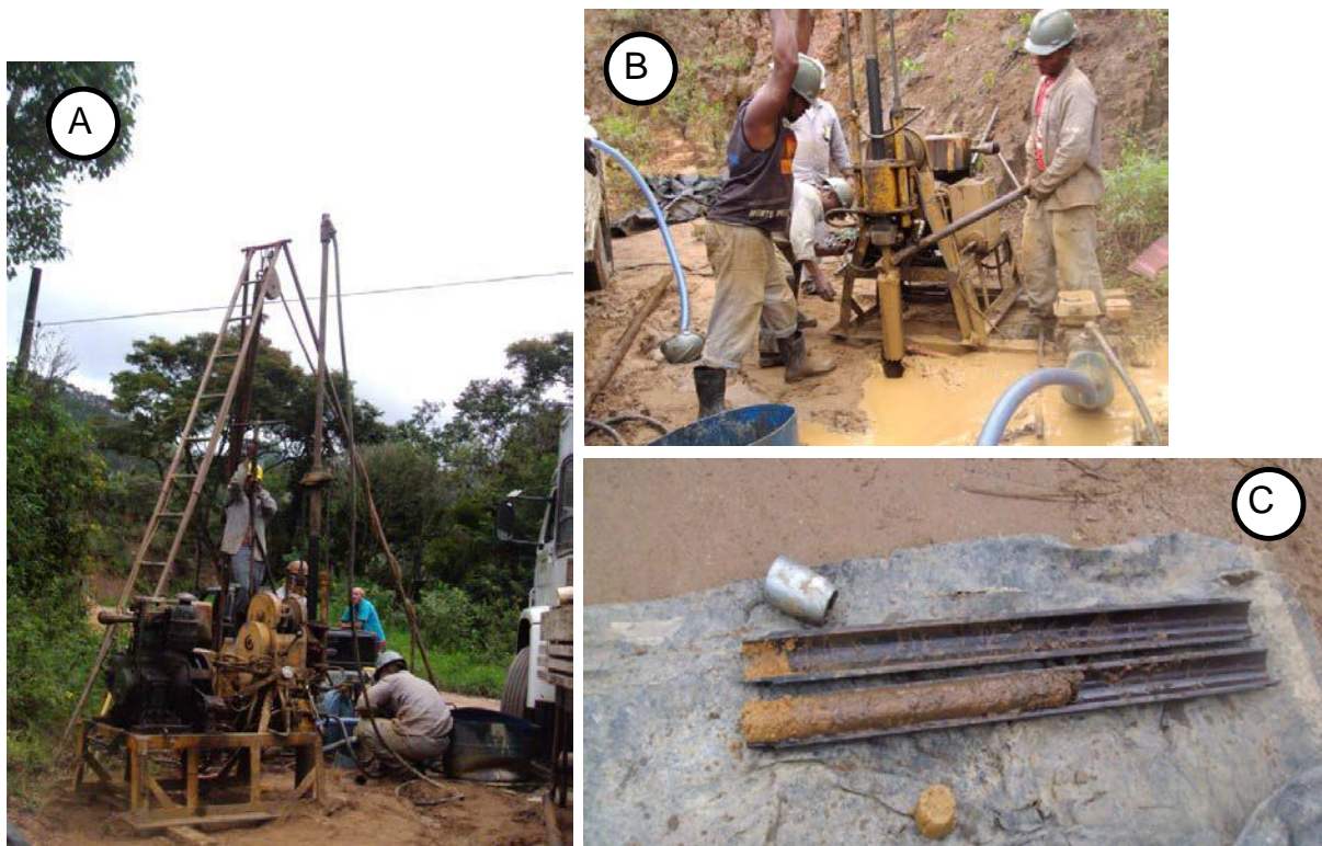
Figura 11: A) Execução da sondagem SPT. B) Início da sondagem rotativa. C) Retirada das amostras do furo SPT com amostrador padrão. Fonte das fotos: Roberta Pereira da Silva.
