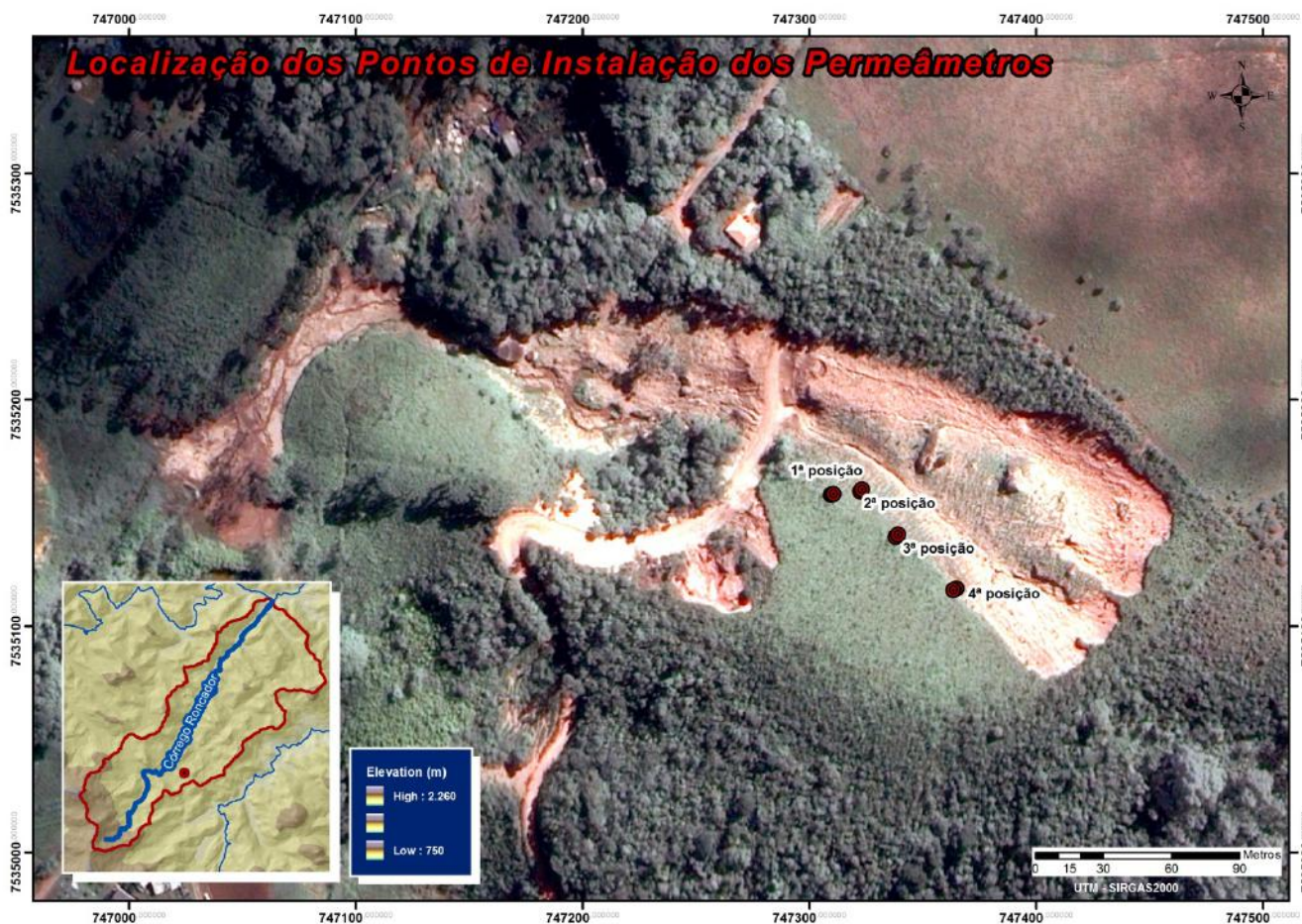
Figura 21: Localização dos pontos de instalação dos permeômetros na encosta.
