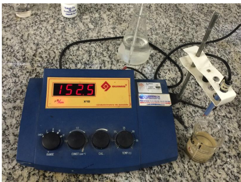
Figura 30. Condutímetro utilizado nos ensaios. Foto do autor.
