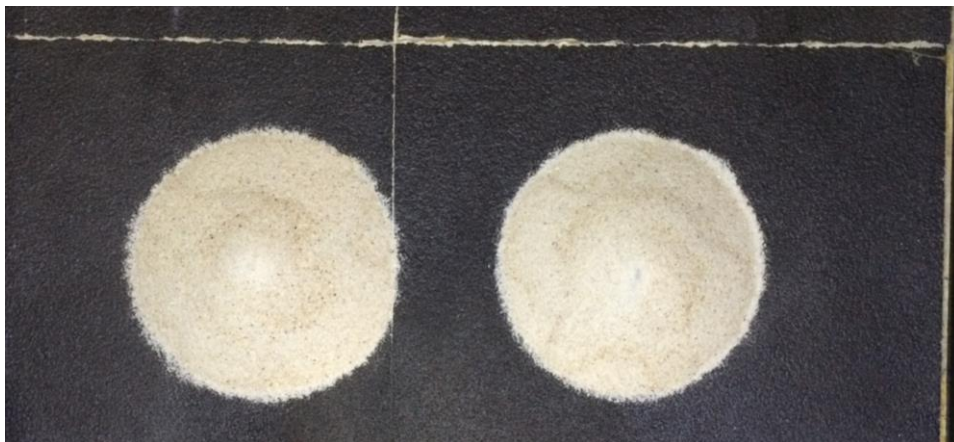
Figura 80. Conformação inicial do terceiro ensaio realizado no túnel de vento. O cone da esquerda está sob influência do sal
