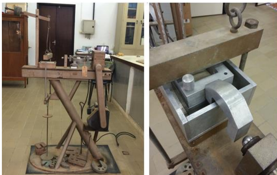
Figura 26. Prensa de cisalhamento direto utilizada (esq.). Detalhe: caixa bipartida já posicionada com a carga vertical aplicada (dir.) (Foto do autor)
