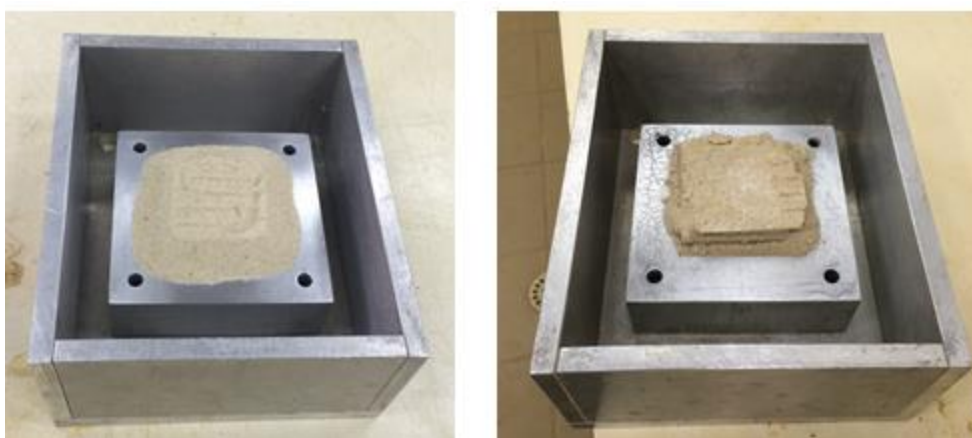
Figura 27. Grãos de areia sem ação coesiva do sal (esq.) e coesos devido a presença do sal (dir.). Observa-se que na imagem da esquerda, os sedimentos desmoronaram
