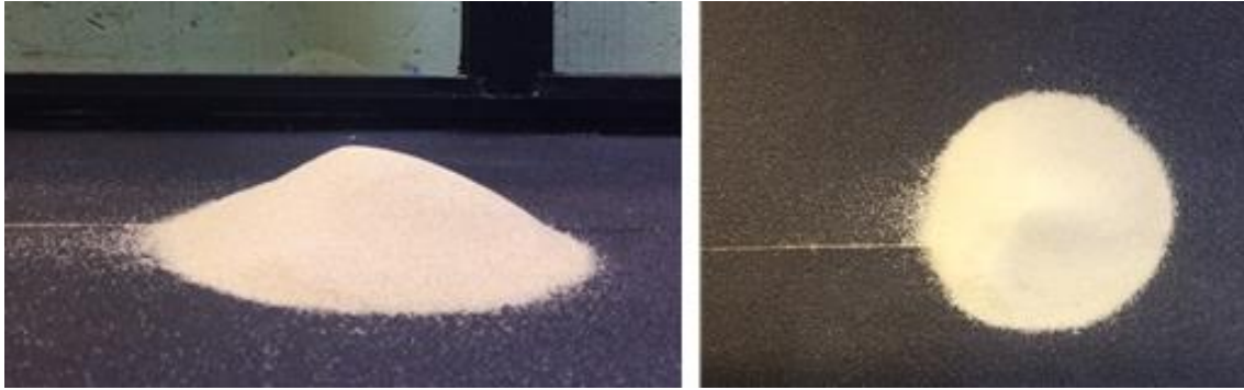
Figura 78. Configuração do segundo teste realizado no túnel de vento após 12h. Amostra: Lençóis
