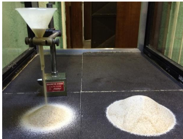
Figura 36. Preparo dos cones de areia para o teste no túnel de vento (Foto do autor)
