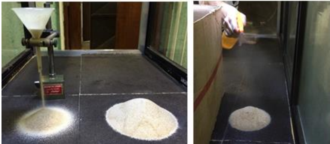
Figura 79. Preparação dos cones de areia e borrifamento de solução salina em um deles para o terceiro ensaio realizado no túnel de vento
