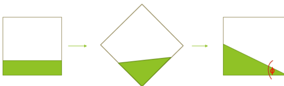
Figura 28. Modelo para determinação experimental do ângulo de repouso. O ângulo de repouso está demarcado na cor vermelha ao fim do modelo.
