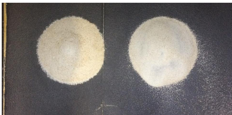
Figura 82. Figura 82. Conformação após 62h de ensaio, sendo as últimas 20h com velocidade do vento aumentada para 4,7 m/s
