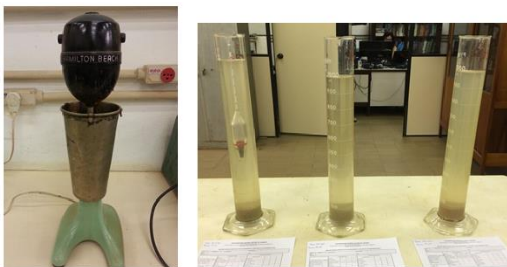
Figura 20. Agitador (esq.) e provetas com o material imediatamente antes de ser agitado manualmente para sedimentação (dir.). Foto do autor.
