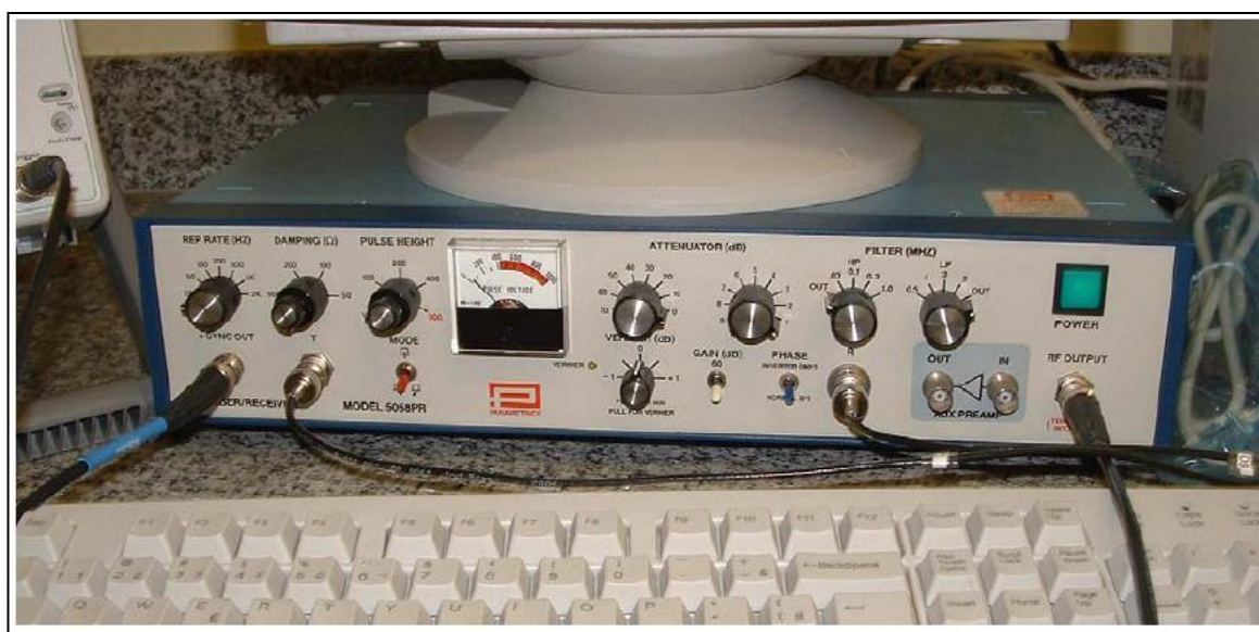
Figura 19 – Pulser-receiver responsável pela geração do sinal elétrico de entrada e amplificação do sinal de saída do tomógrafo. (Fonte: Soares).
