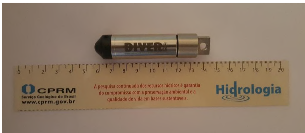
Figura 15: Sensor multiparamétrico mini-diver .
