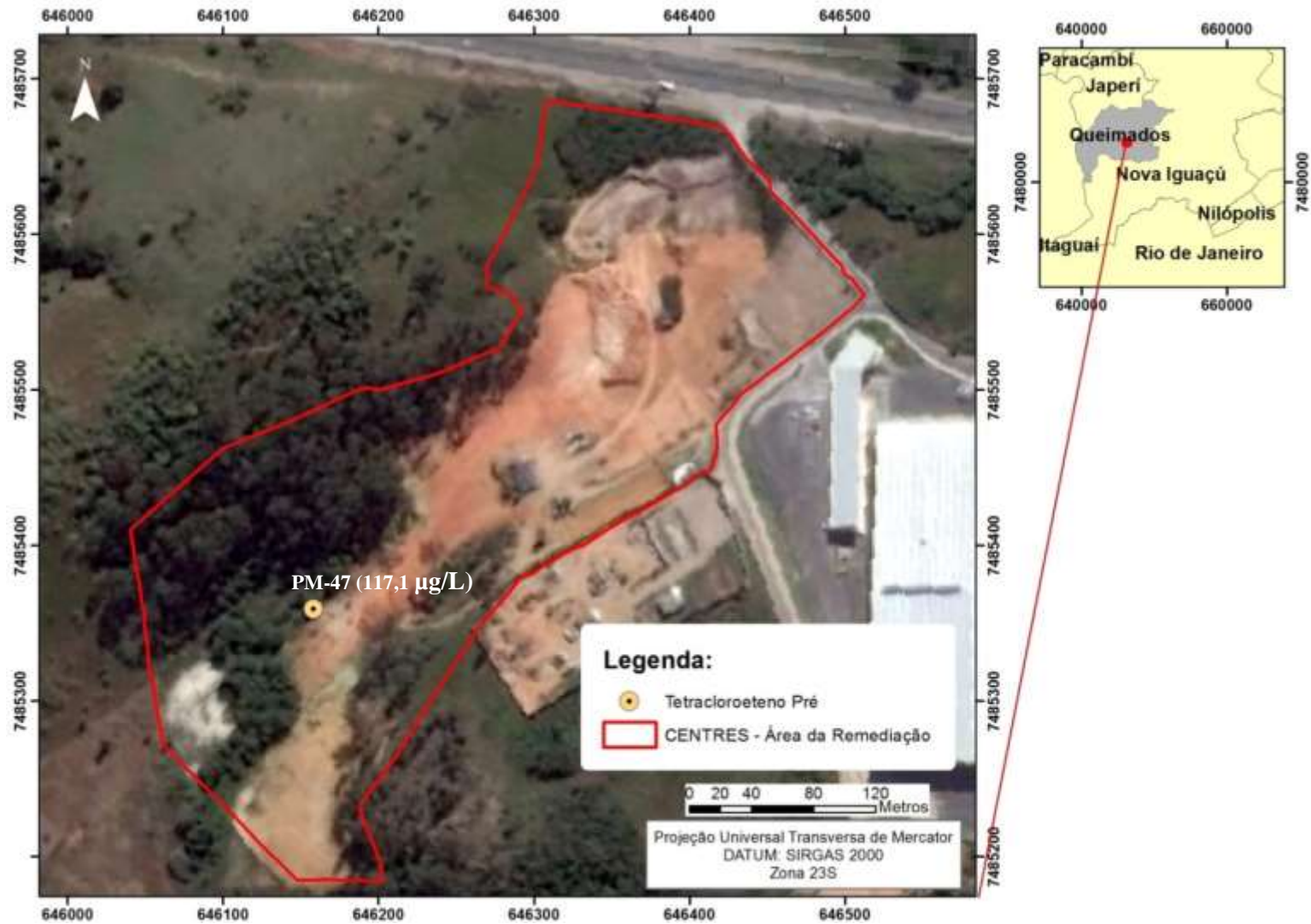
Figura 20 PMs com anomalia do composto Tetrachloroeteno (pré-remediação).
