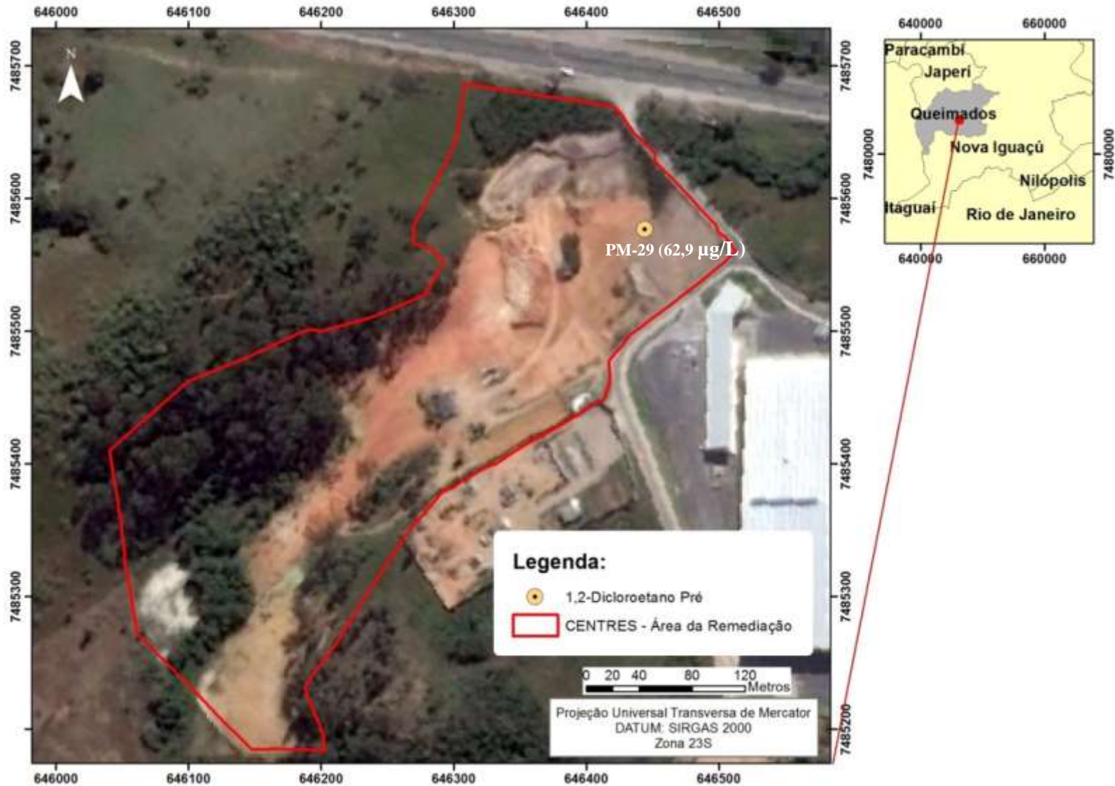
Figura 18 PM com anomalia do composto 1,2-Dicloroetano (pré-remediação).
