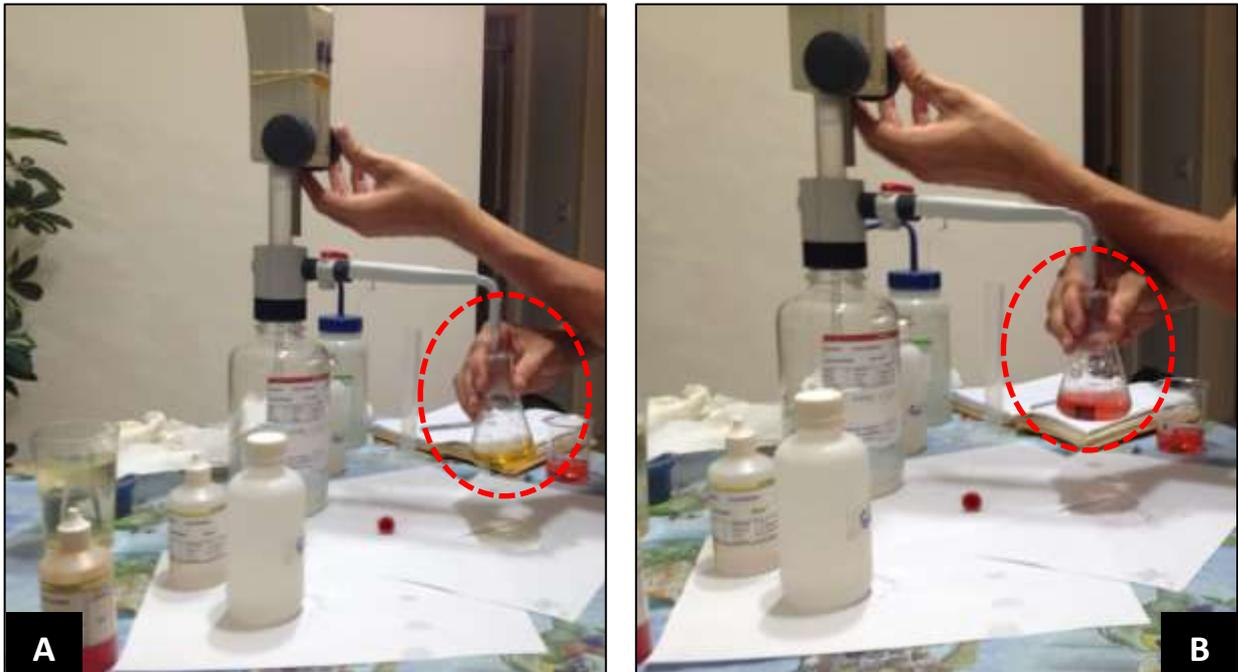
**Figura 18** – (A) Início da titulação com 20 ml de amostra de água coletada com a adição do indicador misto, percebe-se a coloração amarelada; (B) fim da titulação, com a amostra já com a cor avermelhada, indicando que o pH atingiu o valor de 4,5. O aparelho utilizado tanto para adicionar quanto medir o ácido ( $\text{H}_2\text{SO}_4$ ) chama-se bureta eletrônica.
