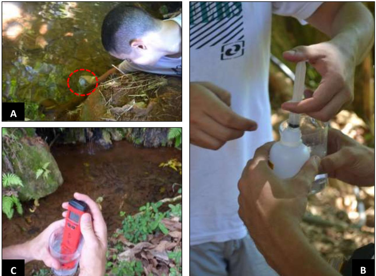
**Figura 17** – (A) Coleta das amostras com o frasco em destaque; (B) filtragem das águas amostradas com um filtro de celulose com porosidade de  $0,45 \mu\text{m}$ , com o auxílio de uma seringa a vácuo; (C) Medição em campo do pH com o aparelho *Hanna HI 98128*. Fotos de janeiro de 2014.
