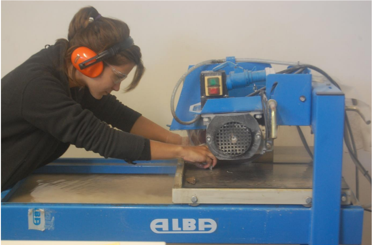
Figura 2 – Utilização da serra diamantada no laboratório do CURE para a redução do tamanho das amostras.
