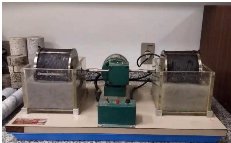
Figura 17 Equipamento utilizado para o ensaio de durabilidade de Slake .
