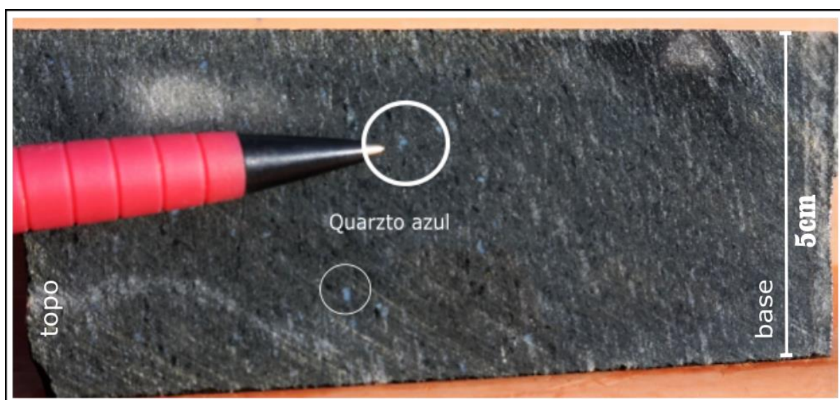
Figura 12 – Testemunho de sondagem com exemplo de metarenito com grânulos de quartzo azul (FAP29~170m).
