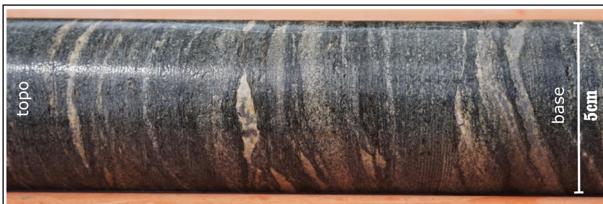
Figura 9 – Testemunho de sondagem de rocha metavulcânica ultramáfica cisalhada, tratando-se de um carbonato biotita talco xisto (FAP14~279m).
