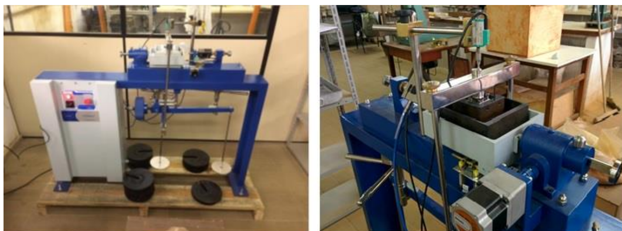
Figura 15: Equipamento de cisalhamento direto Pavitest Cisalhamento. À esquerda: detalhe demonstrando o corpo de prova e o ensaio pronto para ser realizado. Fonte: Fotos da autora.
