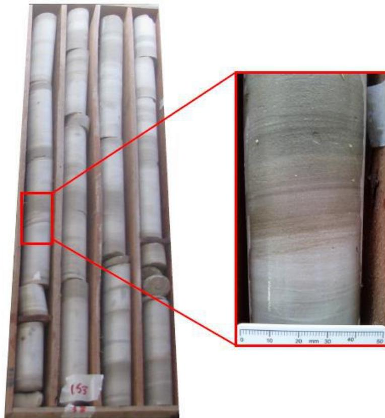
Figura 41 - Caixa número 38 do testemunho descrito, com detalhe em um intervalo em aproximadamente 153,4 m de profundidade. Observar textura da microfácies MF 7 (Packstone a grainstone peloidal com laminação cruzada), de cor cinza-escuro; que encontra-se quase sempre associada a microfácies MF 2 (Mudstone laminado), de cor cinza-claro.
