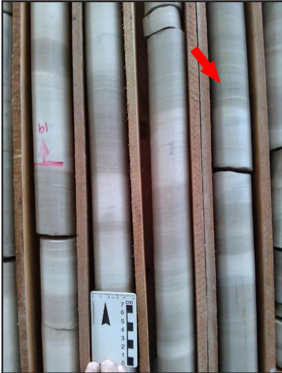
**Figura 51** – Foto das caixas 40 e 41 do testemunho estudado. Observar a associação das MF 7 (Packstone a grainstone peloidal com laminação cruzada), em cinza escuro e MF 2 (Wackestone a mudstone laminado), em cinza claro. Seta vermelha indica estruturas truncadas, que podem indicar fluxo oscilatório.
