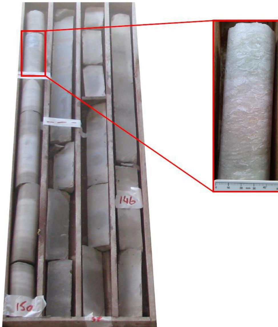
Figura 43 - Caixa número 37 do testemunho descrito, com detalhe em um intervalo em aproximadamente 149,5 m de profundidade. Observar textura da microfácies MF 8 (Floatstone bioclástico).
