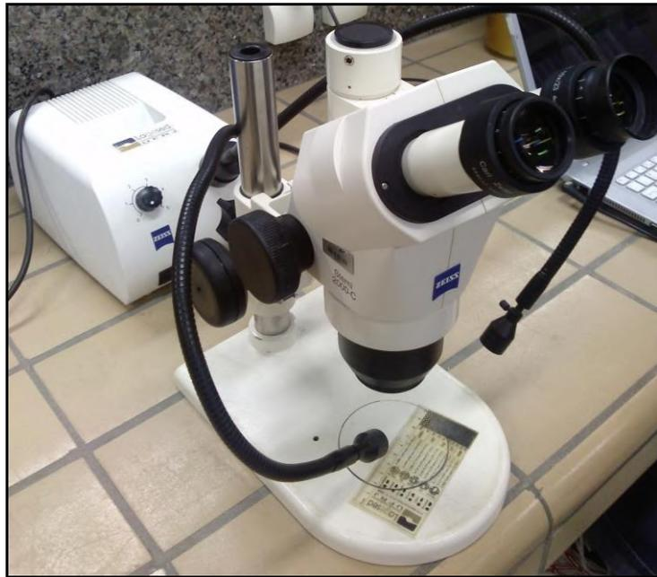
**Figura 5 - Estereomicroscópio utilizado na descrição macroscópica em laboratório.**
