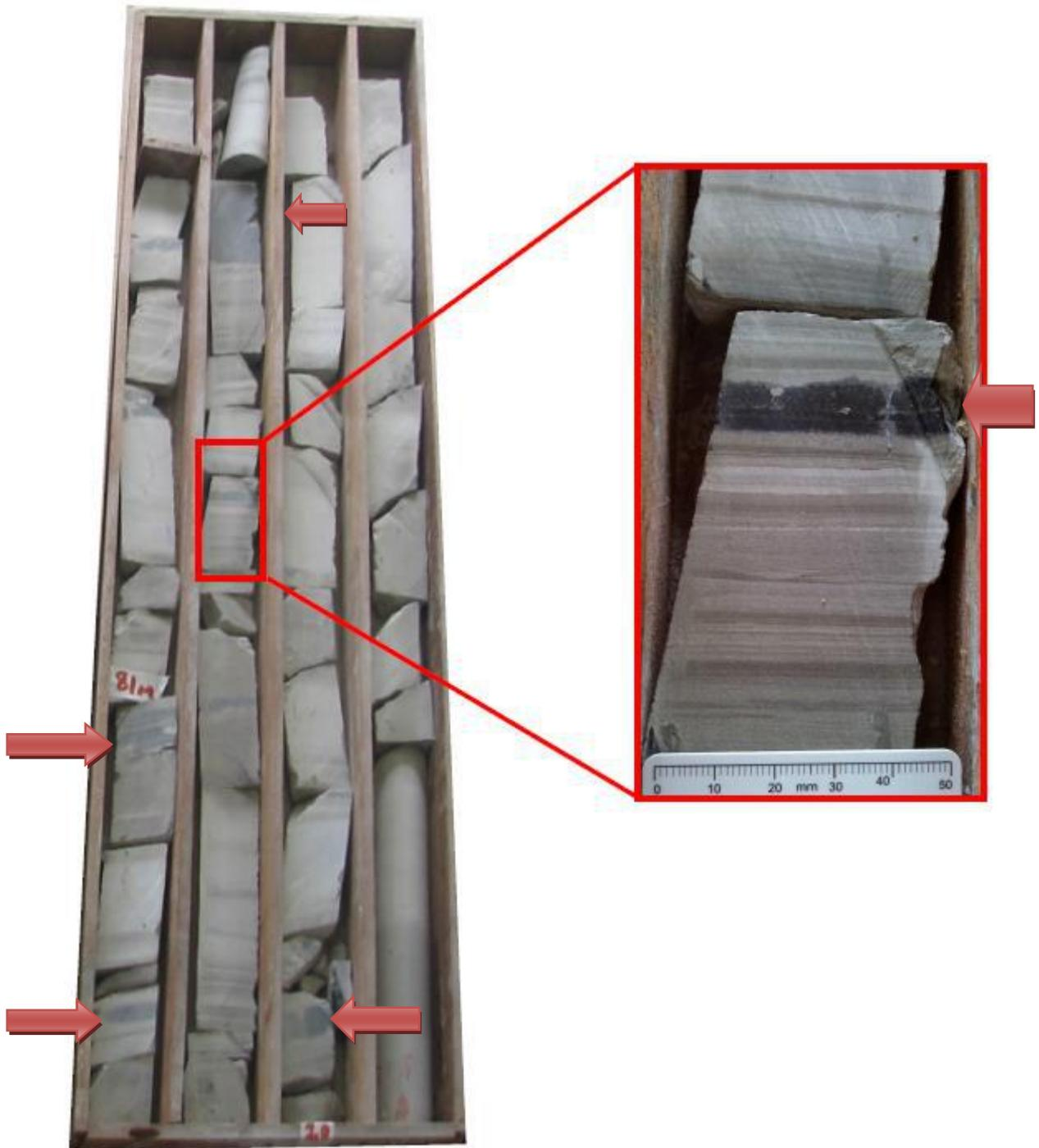
Figura 29 - Caixa número 20 do testemunho descrito, com detalhe em um dos intervalos em aproximadamente 82 m de profundidade representando a microfácies MF 2 (Mudstone a wackestone laminado). Observar laminação plano-paralela e níveis de sílica escura (setas).
