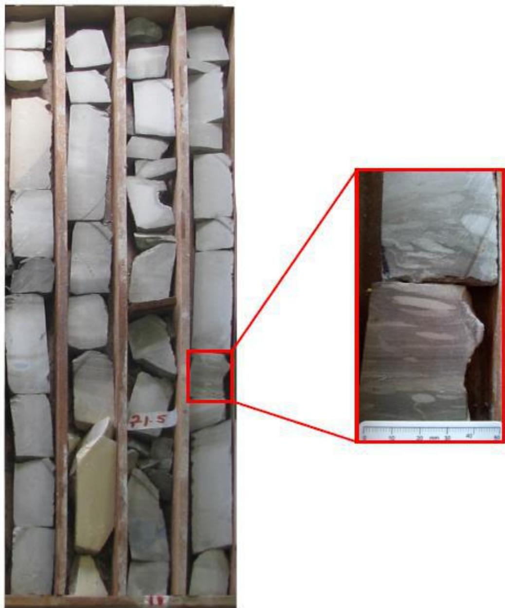
**Figura 39 - Caixa número 18 do testemunho descrito, com detalhe em um intervalo em aproximadamente 70 m de profundidade onde observa-se a textura da microfácies MF 6 (Packstone a grainstone peloidal maciço). Observar também a lente centimétrica laminada e a bioturbação, comuns nesta microfácies.**
