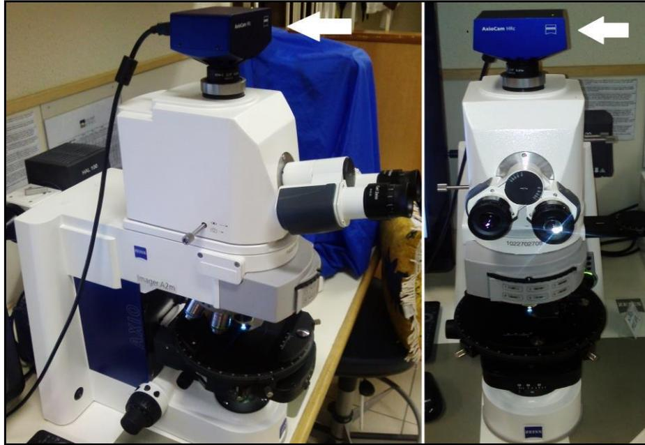
**Figura 6 - Microscópio Zeiss Axio Imager utilizado na descrição petrográfica. Setas brancas indicam a câmera Zeiss AxioCam utilizada para fotomicrografia.**
