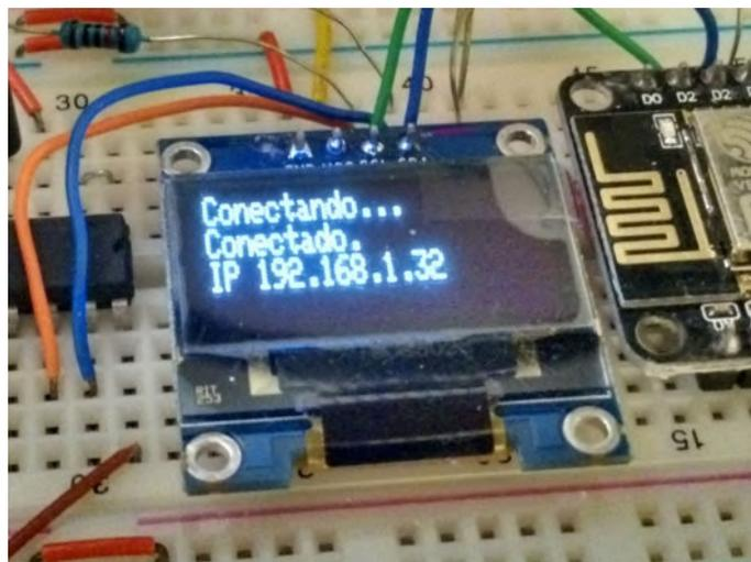
Figura 11: Display exibindo informações da conexão Wi-Fi
