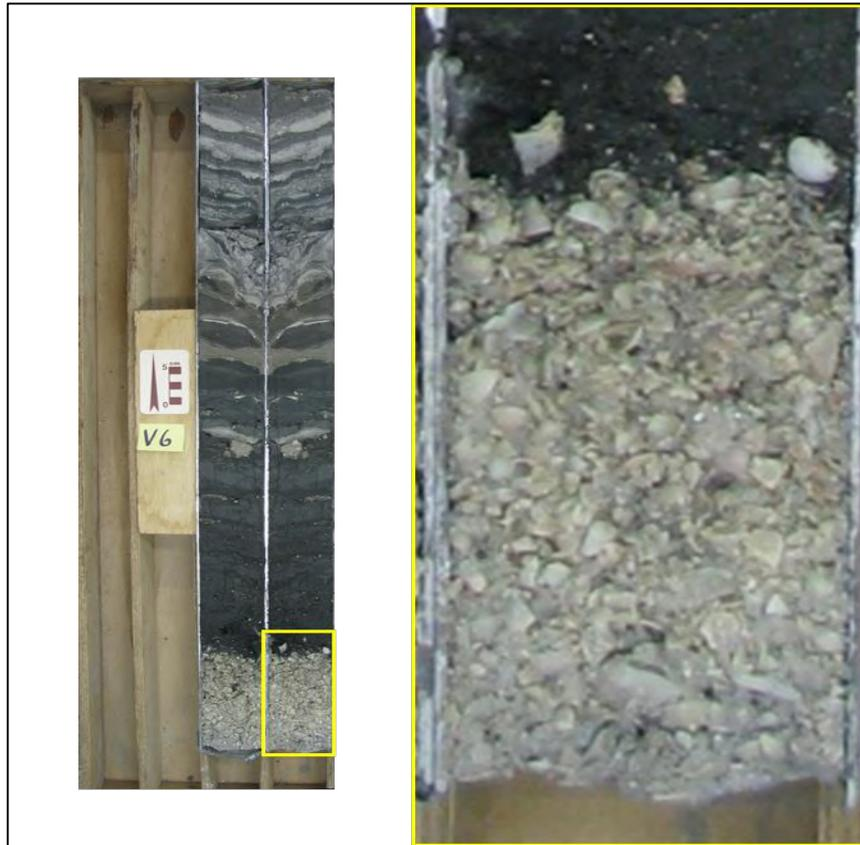
**Figura 36** - Intervalo do testemunho LV-06 onde foi realizada a análise granulométrica.
