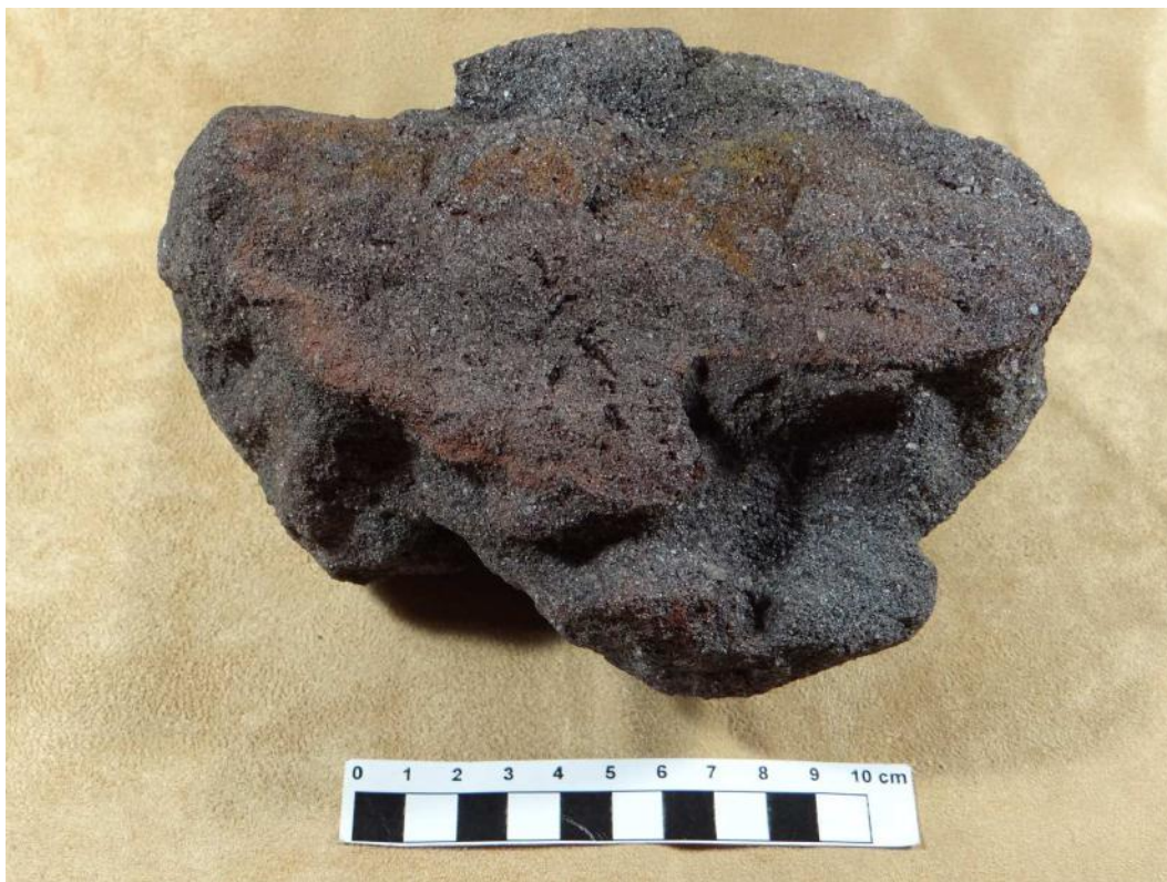
Figura 20: Amostra 978: arenito ferruginoso, Pará. Escala em centímetros. (Fotografia: Antonio Carlos Sequeira Fernandes)
