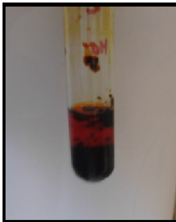
Figura 10 – Ensaio positivo para molibdênio com solução de tiocianato de amônio
