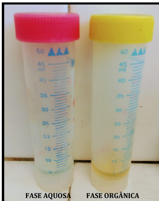
Figura 9 – Fase aquosa e fase orgânica, respectivamente, da extração 20 % v/v de Alamina 304 em n-heptano
