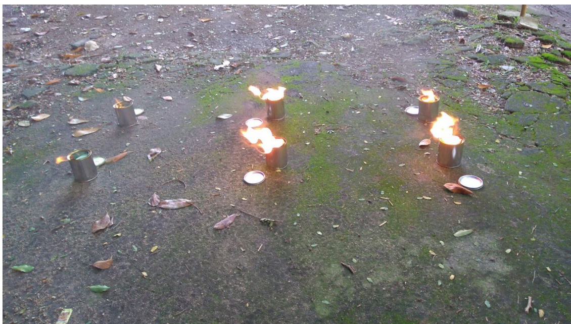
Figura 2: Experimentos de simulação de incêndio. Da esquerda para a direita: EHC, gasolina e óleo diesel sendo queimados com espuma.
