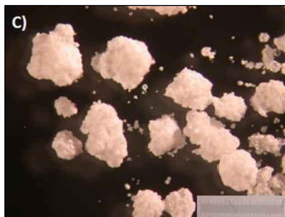
Figura 14: Micrografias eletrônicas por varredura (MEV) e ótica (MO) de partículas casca-núcleo de poli(benzoato de vinila-co-estireno)/poliestireno. A) partícula parcialmente recoberta; B) Superfície da casca de poli(benzoato de vinila-co-estireno) formada; C) micrografia ótica de partículas casca-núcleo de poli(benzoato de vinila-co-estireno)/poliestireno, tamanho da régua de 1000μm.
