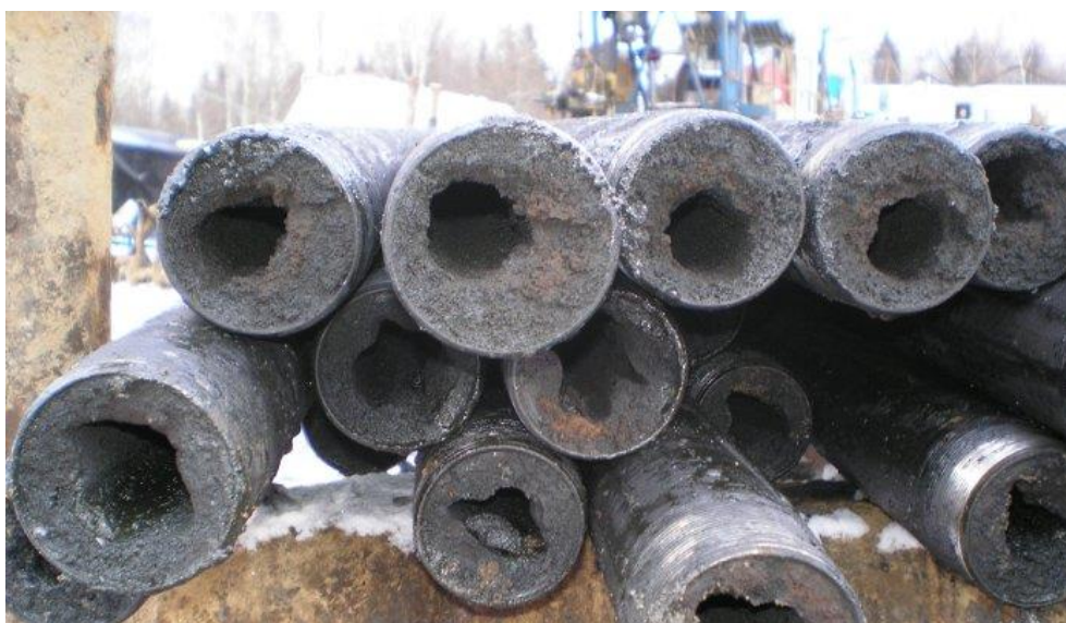
Figura 2: Tubulações com asfaleno precipitado
