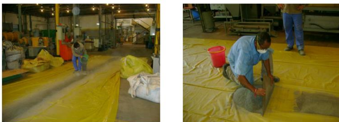
Figura 14 -Preparação da amostra: homogeneização da amostra em pilha prismática e retirada de alíquotas de 20 kg. Fonte: Felix, 2014, p. 45.
