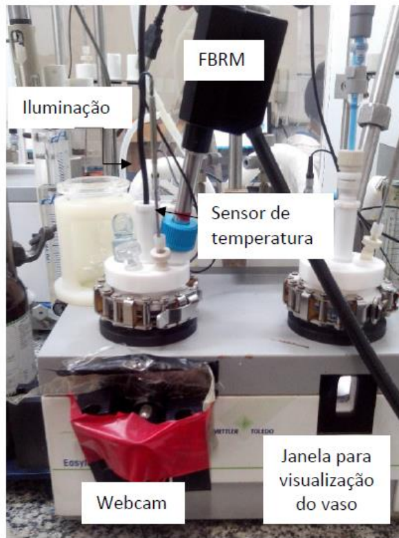
Figura 20: Esquema experimental para baixas concentrações utilizando o reator EasyMax 102 automatizado. Aponta-se na figura o uso da webcam , sensor de temperatura, a probe do FBRM e o a iluminação feita através do led.
