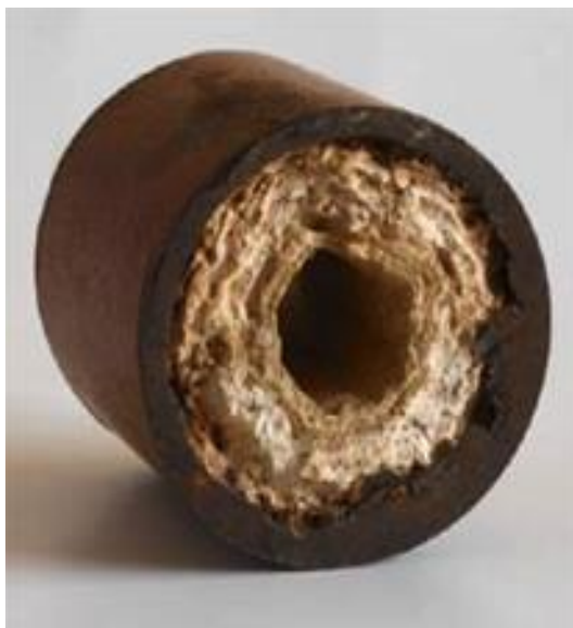
Figura 2: Incrustação causada por deposição inorgânica. (luminoruv.com, 2016)
