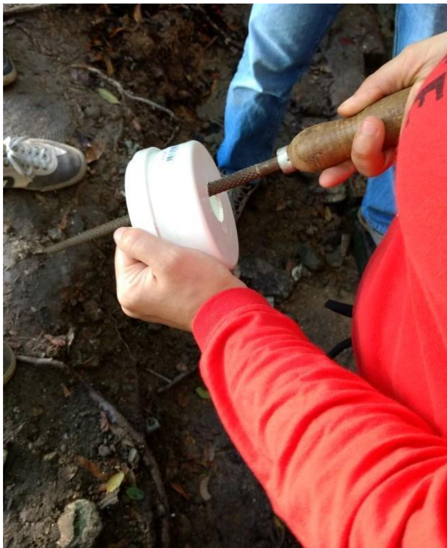
Figura 11: Ajuste do diâmetro do CAP para inserção de sistema autolimpante.
