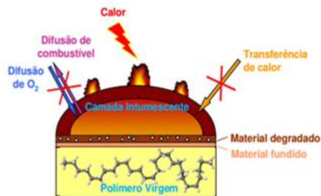
Figura 2 – Esquema da formação da camada intumescente protegendo a matriz polimérica (Estevão, 2002).
