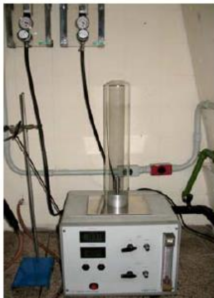
Figura 7 – Equipamento utilizado para medir o índice limite de oxigênio (Ribeiro, 2007)
