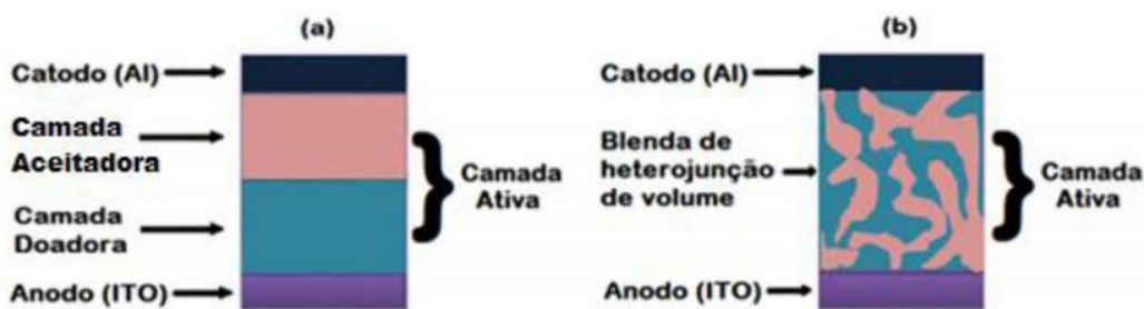
Figura 4 – Esquema das seções transversais de células fotovoltaicas orgânicas (a) do tipo bicamada e (b) do tipo heterojunção de volume (BORGES, B.G.A.L., 2015).
