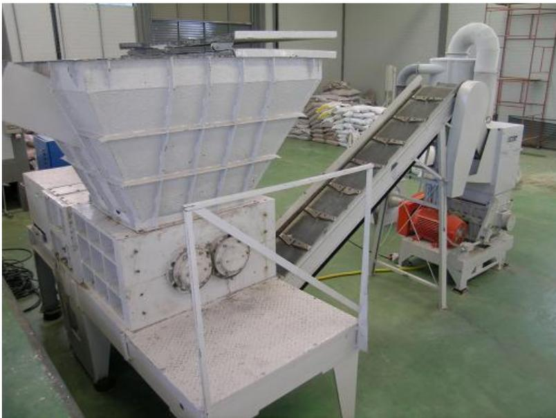
**Figura 3.** Equipamento para trituração/cominuição de PCI
