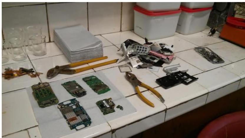
**Figura 4:** Isolamento manual das PCI de telefones celulares
