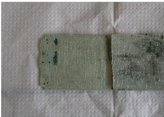
**Figura 8.** PCI após lixiviação
