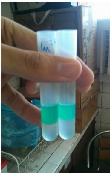
**Figura 11.** Aspecto das fases aquosa (inferior) e orgânica (superior) após extração do cobre(II) com D2EHPA 6% vol. em n-heptano (pH 5), um estágio.
