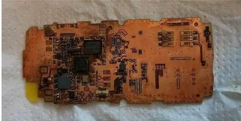
**Figura 12** Aspecto da placa de PCI após remoção da resina protetora. O brilho devido ao cobre é bem nítido
