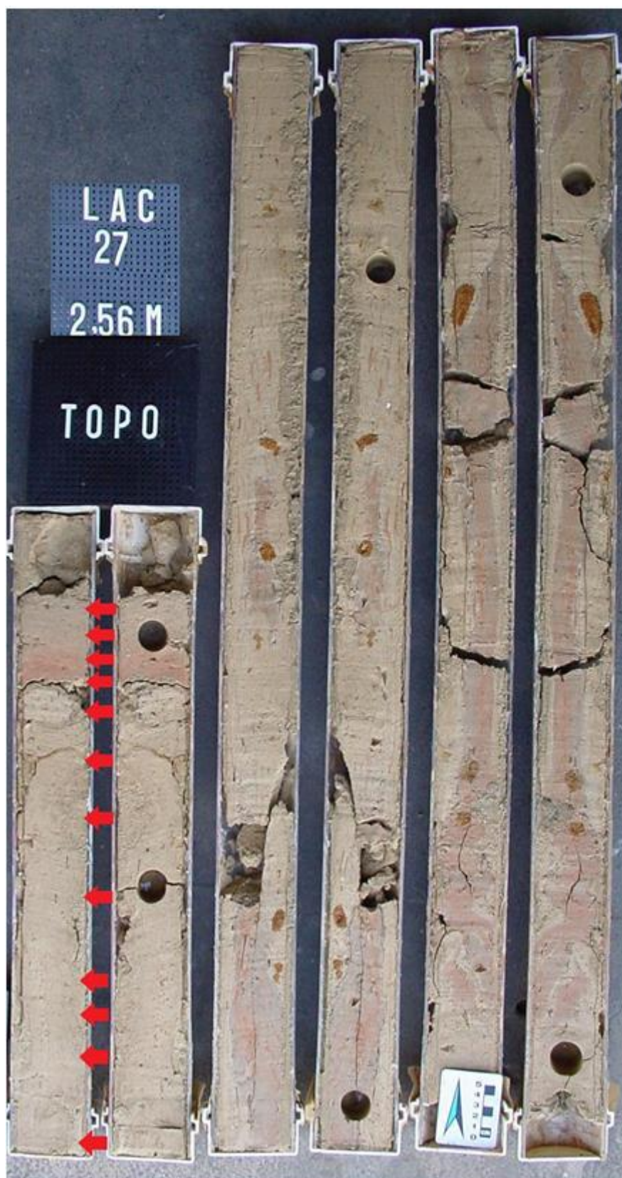
Figura 7: Testemunho LAC-27. As setas vermelhas representam as profundidades das quais foram coletadas as amostras estudadas no presente trabalho.
