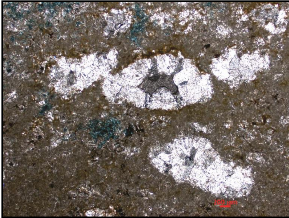
Figura 43 - Fotomicrografia do wackestone peloidal (MF2), (XP). Observar vugs de dissolução preenchidos por cimento blocoso interpretado como precipitado no regime diagenético de soterramento intermediário a profundo.
