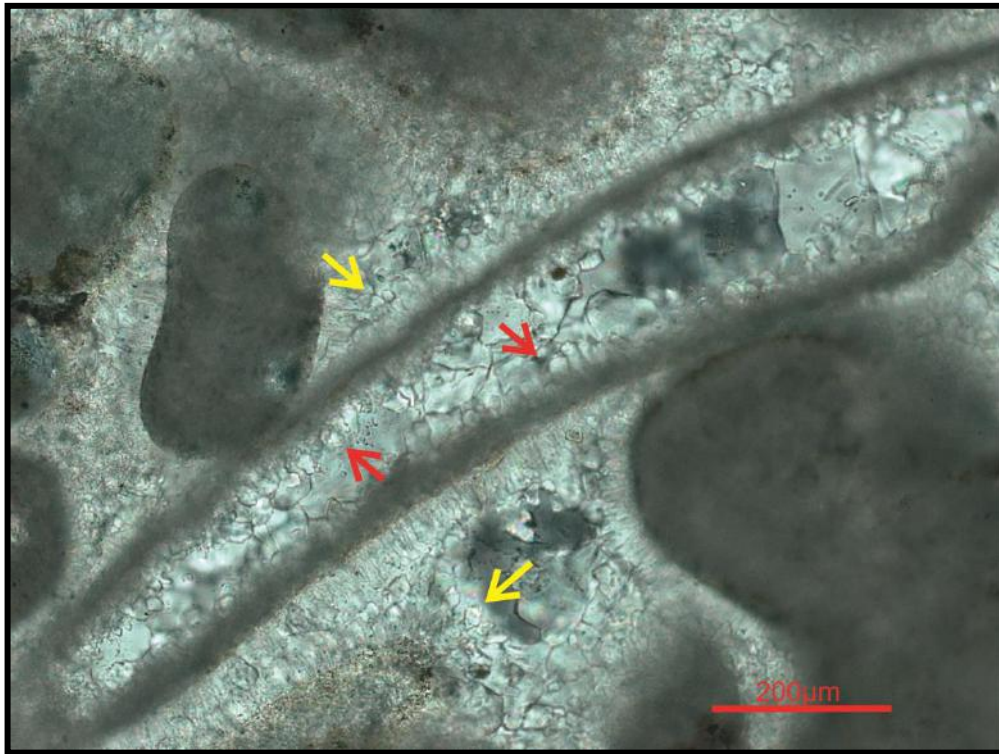
Figura 37 - Fotomicrografia do grainstone oolítico bioclástico intraclástico (MF6), (XP). Observar cimento isópaco prismático equigranular em franja precipitado no interior de fragmento de bivalve previamente dissolvido (setas vermelhas). Este cimento também é identificado preenchendo o espaço poroso intergranular, precipitado diretamente na superfície do grão ou sobre cimento isópaco fibroso em franja. Setas amarelas apontam para cimento isópaco prismático equigranular em franja precipitado sobre cimento isópaco fibroso em franja.
