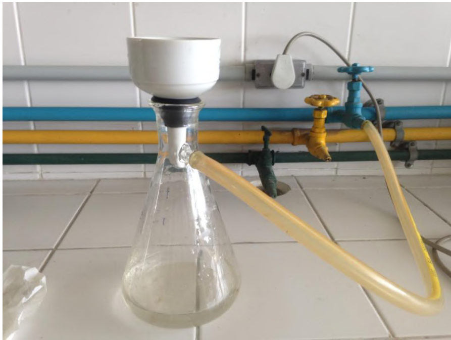
Figura 4 – Filtração à vácuo realizada para separar os sólidos insolúveis do efluente.
