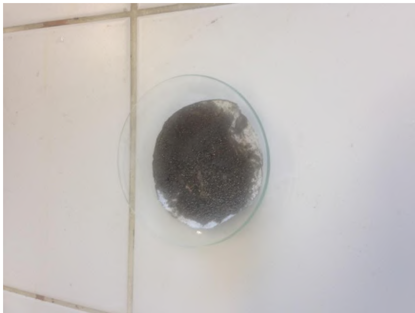
Figura 5 – Aspecto do sólido insolúvel após a separação por meio da filtração à vácuo.
