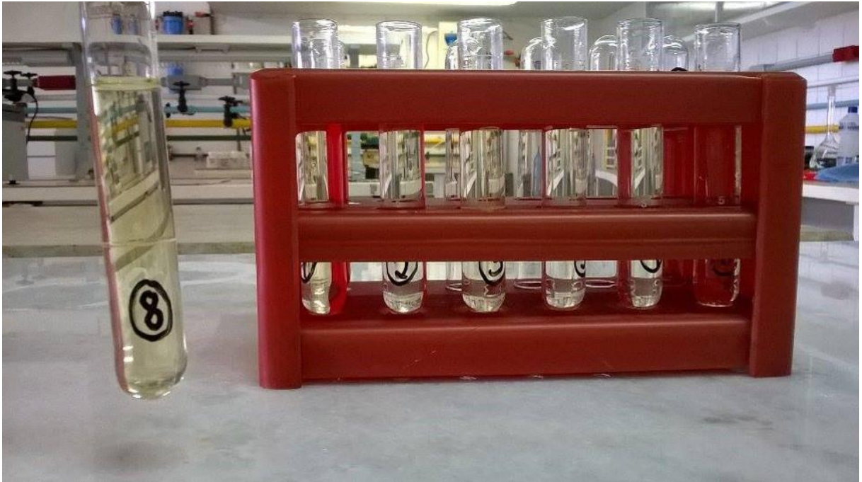
Figura 4 - Preparação da curva para a determinação de fosfato
