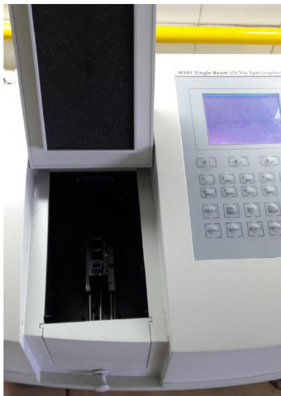
Figura 5 - Espectrofotômetro CamSpec modelo M501 Single Beam UV/Vis
