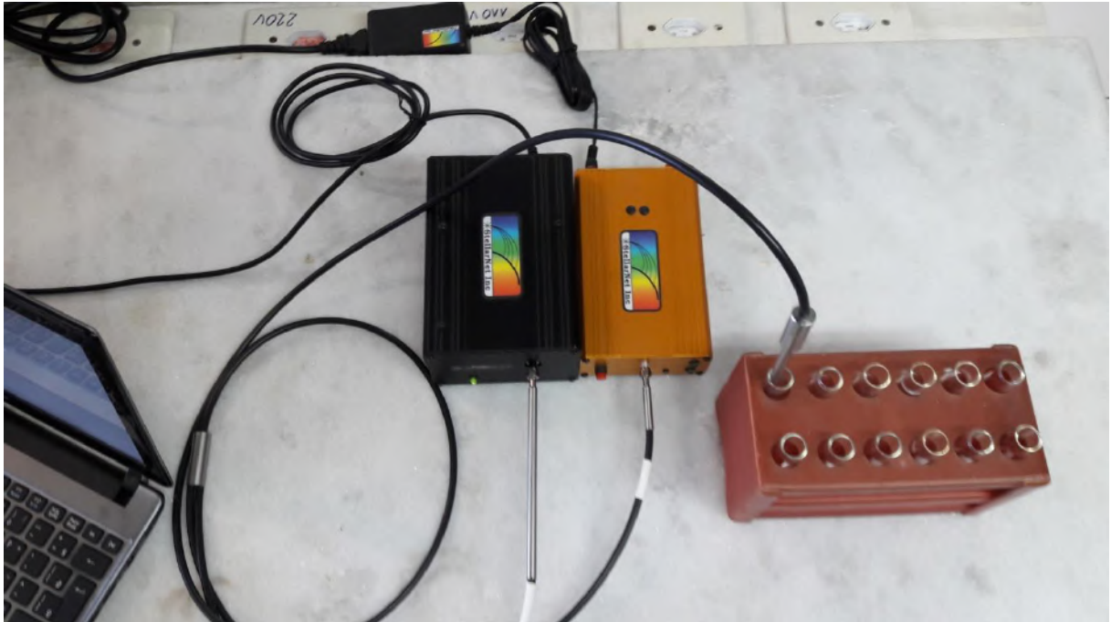
Figura 6 - Espectrofotômetro portátil com célula de imersão da StellarNet modelo SL5-DH Deuterium+Halogen Lamps
