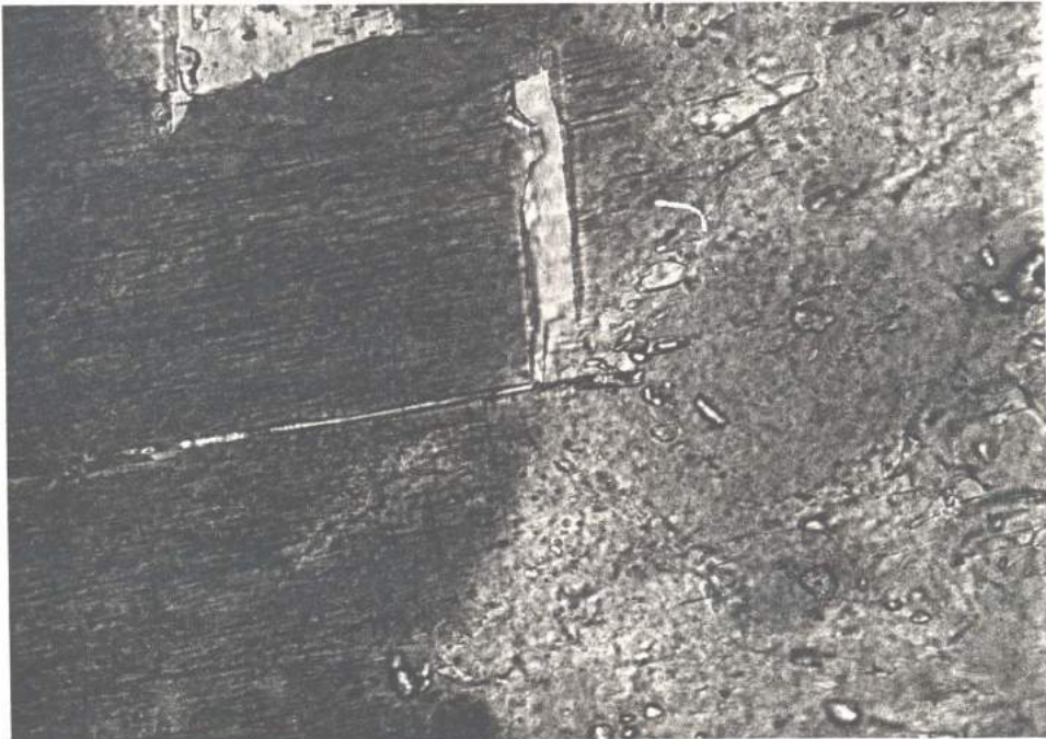
FOTOMICROGRAFIA 11 - Transformação de um cristal de hornblenda (marrom) com inclusões de titanita e ilmenita nas clivagens, para um cristal de actinolita (verde clara) e ausente das referidas inclusões, em rocha metadiorítica pertencente a Unidade Metadiorítica Ibitutinga. Pode-se observar o início do processo de biotitização da hornblenda (Ponto U). Na actinolita desenvolvem-se pequenos cristais de epidoto (Ponto V) Ponto CT-A. Aumento de 200,0 X. Nicóis paralelos.
