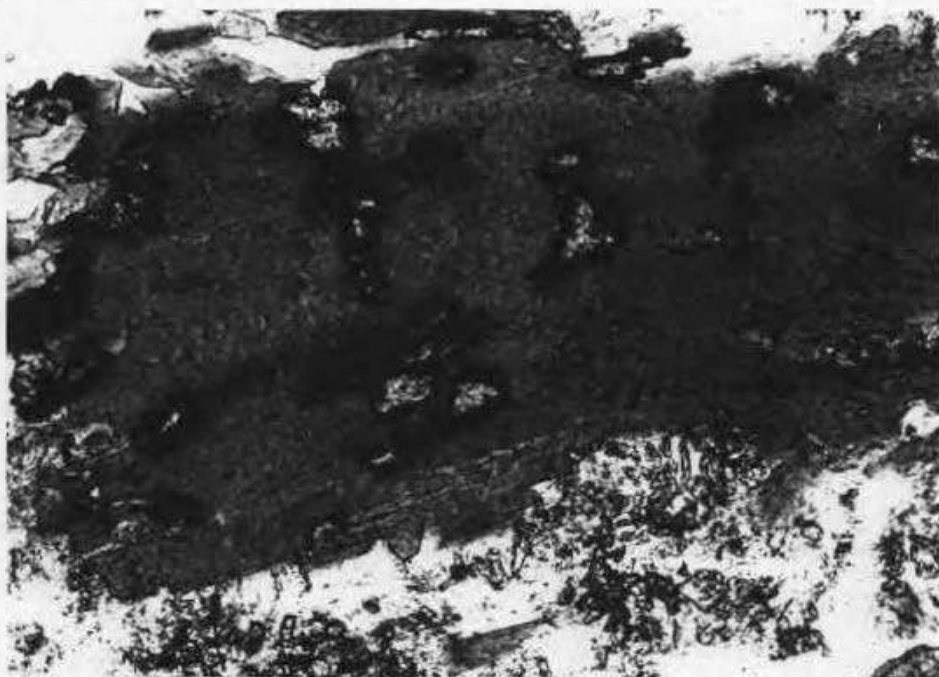
FOTOMICROGRAFIA 16 - Exsolução de cristais xenoblásticos de titanita na biotita, formando uma textura poiquiloblástica; rocha quartzo monzodiorítica do Meta Quartzo Monzodiorito Glória, pertencente a Unidade Metadiorítica Ibitutinga. Ponto CT-335A. Aumento de 100,0 X. Nicóis paralelos.
