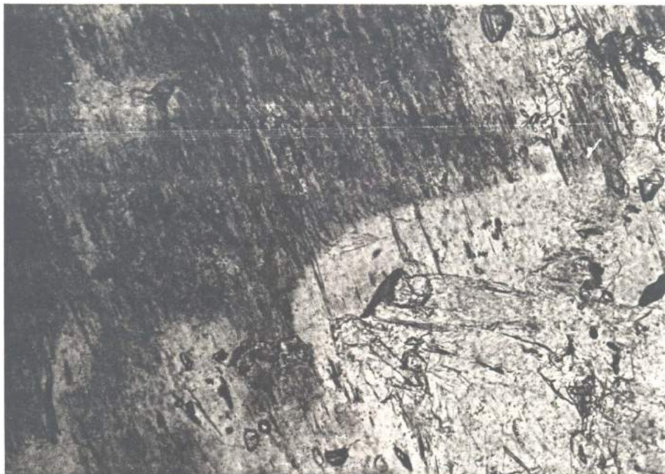
FOTOMICROGRAFIA 5 - Substituição parcial de hornblenda (marrom) por actinolita (verde clara) nas rochas anfíbolíticas do Greenstone Belt Barbacena. A hornblenda encontra-se cheia de inclusões de titanita e minerais opacos, representados pelas ripas mais escuras. Ponto CT-132. Aumento de 100,0 X. Nicóis paralelos.
