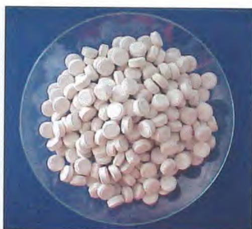
Figura 7.62 – Comprimidos de B. thuringiensis var. israelensis em meio MBti-Glicose, obtidos com o floculante \text{CaCl}_2 \cdot 2\text{H}_2\text{O} e utilizados nos testes de campo
