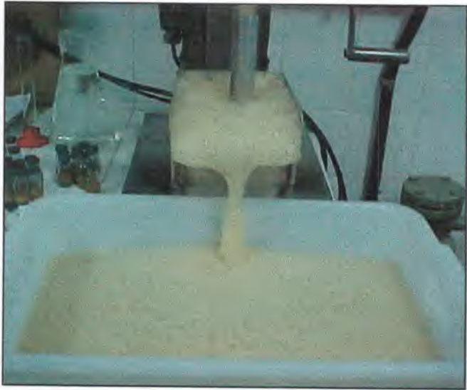
Figura 7.53 – Flotação de B. sphaericus (600ppm Flotigan; 960rpm; 6L ar/min; pH 7,0)
