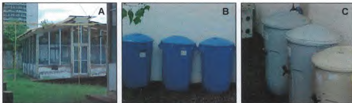
Figura 6.10 – Testes de campo simulado. (A) Casa de vegetação onde os experimentos foram realizados; (B) Recipientes plásticos de 100L; (C) Recipientes plásticos de 100L com abertura para o escoamento de água
