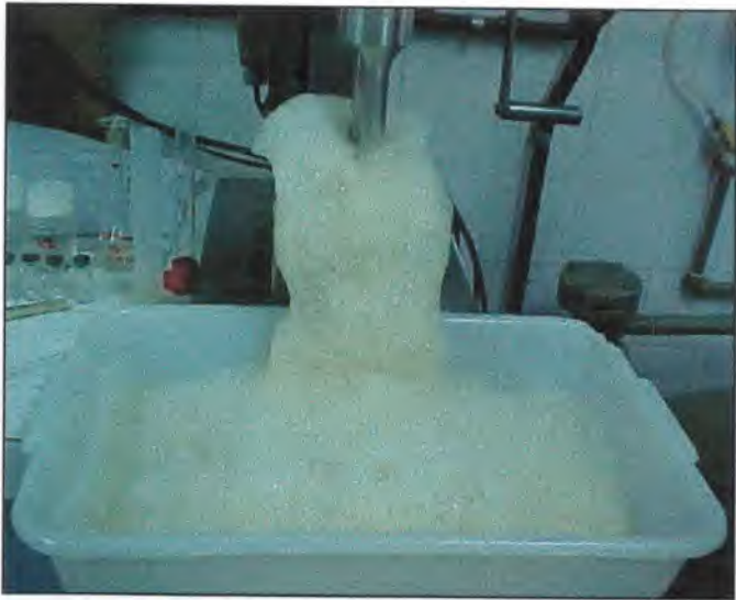
Figura 7.51 – Flotação de B. sphaericus (80ppm Flotigan, 750ppm Tween, 960rpm; 6L ar/min; pH 8,9).
