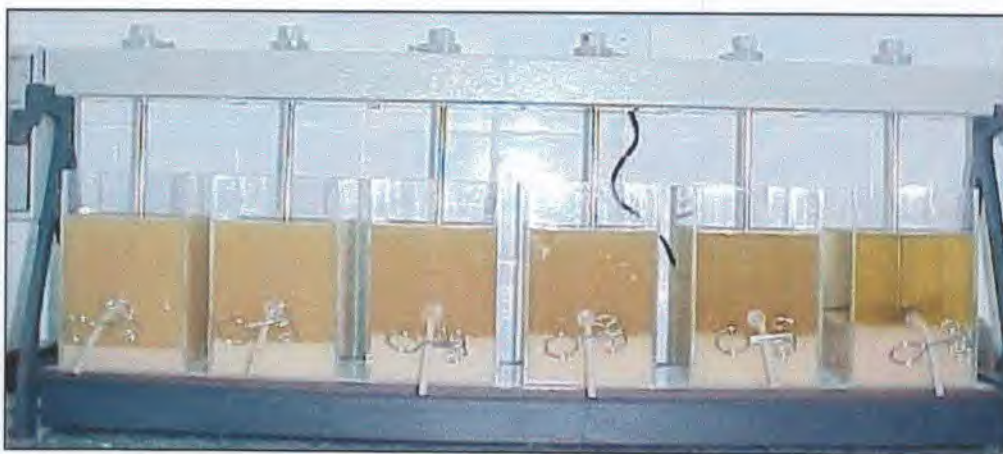
Figura 6.5 – Teste de jarro com o caldo fermentado de B. thuringiensis var. israelensis em meio MBti-Glicose utilizando \text{Al}_2(\text{SO}_4)_3 como agente floculante
