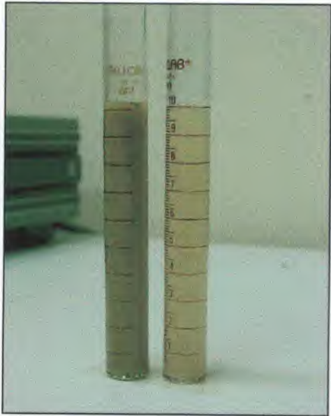
Figura 7.59 – Amostras de B. sphaericus em meio MBS flotada (esquerda) e original (direita) (Qar=1240mL/min; pH 8,9)
