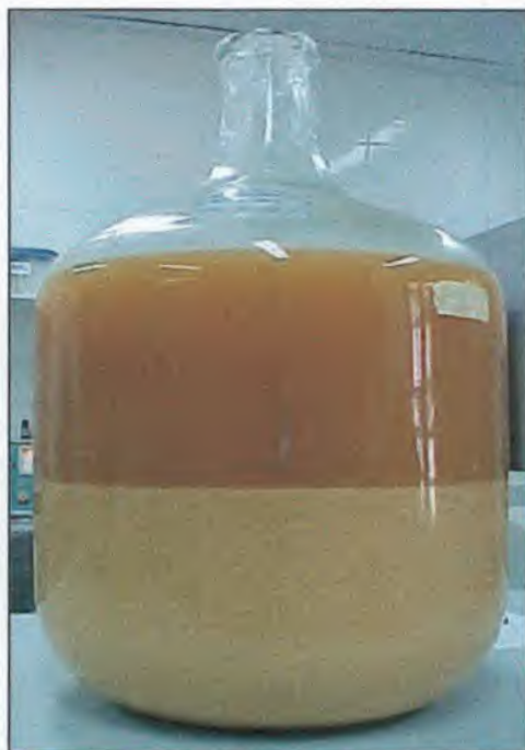
Figura 7.15 – Caldo fermentado de B. sphaericus em meio MBS-6 floculado na condição de pH 3,0 (amostra de 60L)
