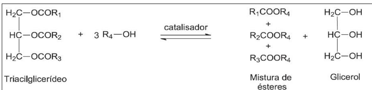
**Figura 4.** Reação de transesterificação do éster do glicerol com álcool primário [LOTERO *et al.*, 2005].
