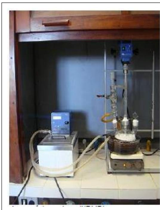
**Figura 14.** Aparelhagem utilizada na síntese do poli(DVB).
