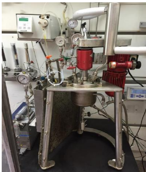
Figura 14 - Sistema utilizado na avaliação e seleção de sequestrantes de H 2 S em petróleo (Imagem cedida por Petrobras CENPES)
