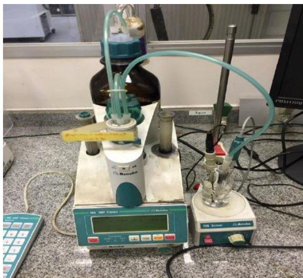
Figura 10 - Titulador automático 785 DMP Titrimo Metromh ® utilizado para determinação de sulfeto ( S^{2-} ) na fase líquida (foto: Petrobras /CENPES)
