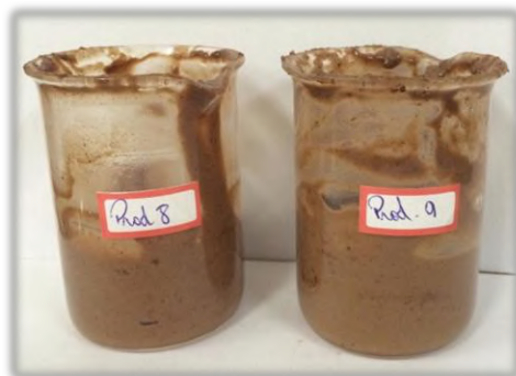
Figura 22. Emulsões preparadas com as mesmas razões volumétricas de óleo e água, 60 e 40 , respectivamente, e contendo 2g de emulsificante para 50 mL de emulsão. Os sistemas foram preparados utilizando os produtos Tanmod-8 e 9 como emulsificantes.
