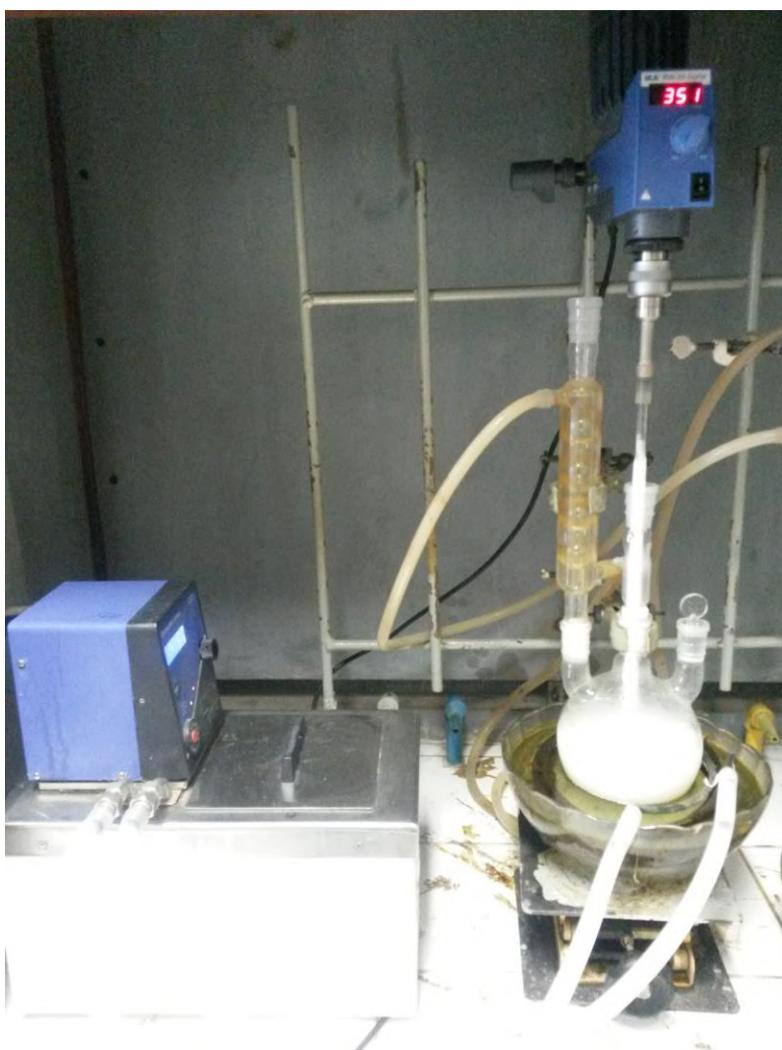
**Figura 5:** Aparelhagem utilizada na síntese dos copolímeros AN-DVB
