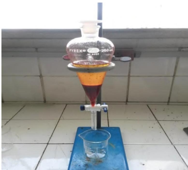
**Figura 6:** Purificação dos monômeros: lavagem com NaOH 5% m/v
