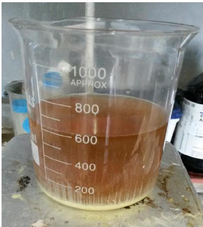
**Figura 11:** Formação de precipitado amarelo claro de peróxido de uranila no fundo do béquer
