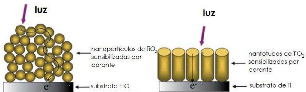
**Figura 6** Comparação dos caminhos percorridos pelos elétrons através de nanopartículas de  $\text{TiO}_2$  (esquerda) e de estruturas nanotubulares de  $\text{TiO}_2$  (direita). Adaptada de Yan & Zou, 2011.
