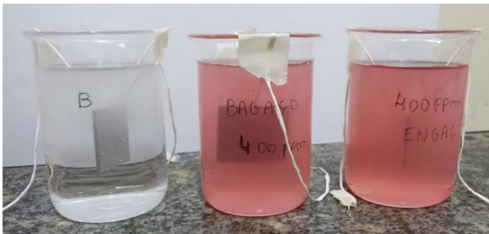
Figura 4.4: Ensaio de perda de massa do aço-carbono 1020 em meio aquoso de HCl 1 mol L -1 , na ausência e presença dos extratos do bagaço e engaço na concentração de 400 mg L -1 .
