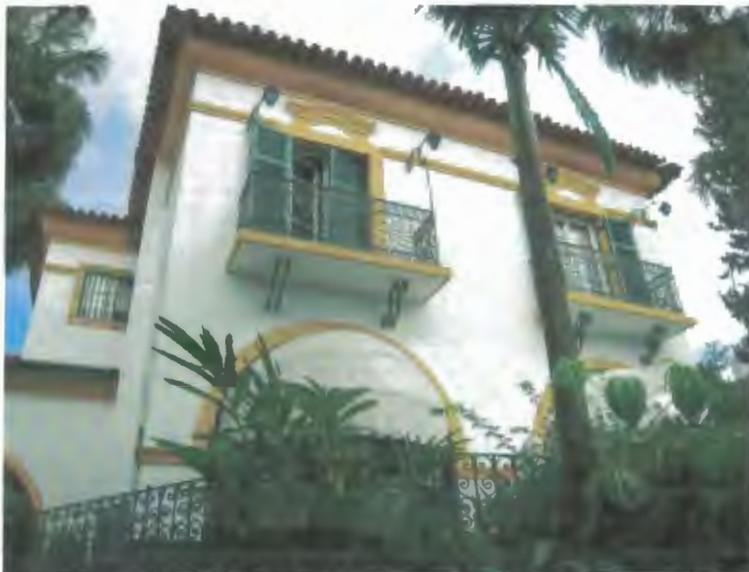
Figura 3 - Elementos na fachada principal que remontam à arquitetura colonial brasileira: gelosias, arcos em canga-de-bol e beiral aparente. Ano: 2007. Fotógrafo: Edilson Coelho
