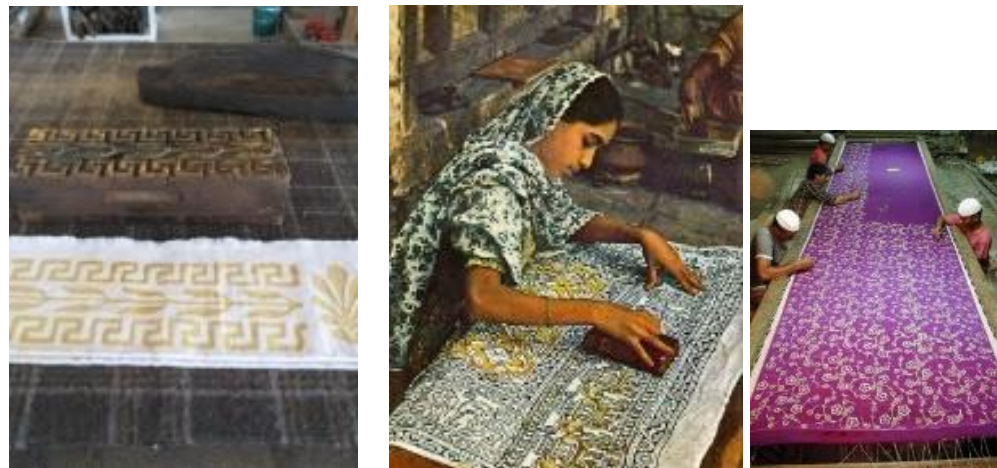
Imagem 16. Bloco de madeira Pêra esculpido à mão do século XVIII, usados na estampagem de tecidos com pasta ferrugem. Processo de estampagem por pressão da matriz no tecido.
