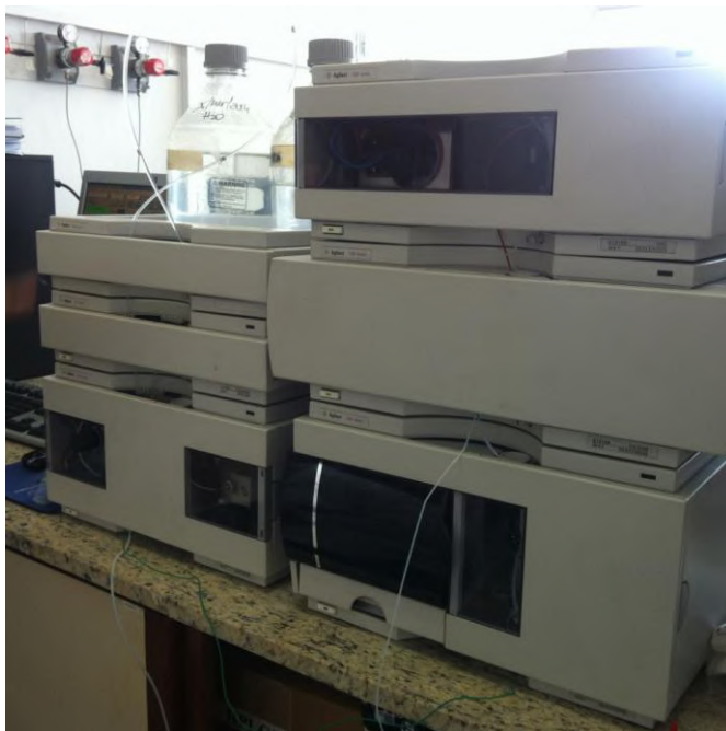
Figura 13: Sistema de cromatografia a líquido de alta eficiência, modelo 1100 Series ( Agilent Technologies ). Fonte: o autor.
