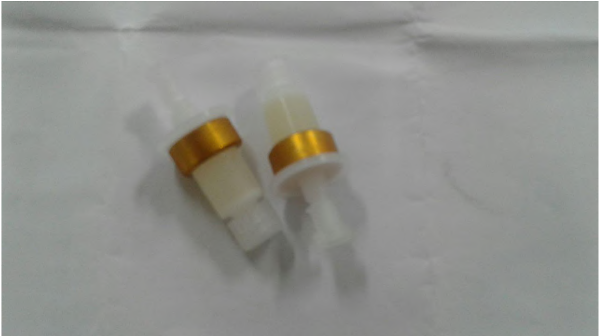
Figura 7: Cartucho SKC (C18) para a coleta de compostos carbonílicos no ar. Fonte: o autor.
