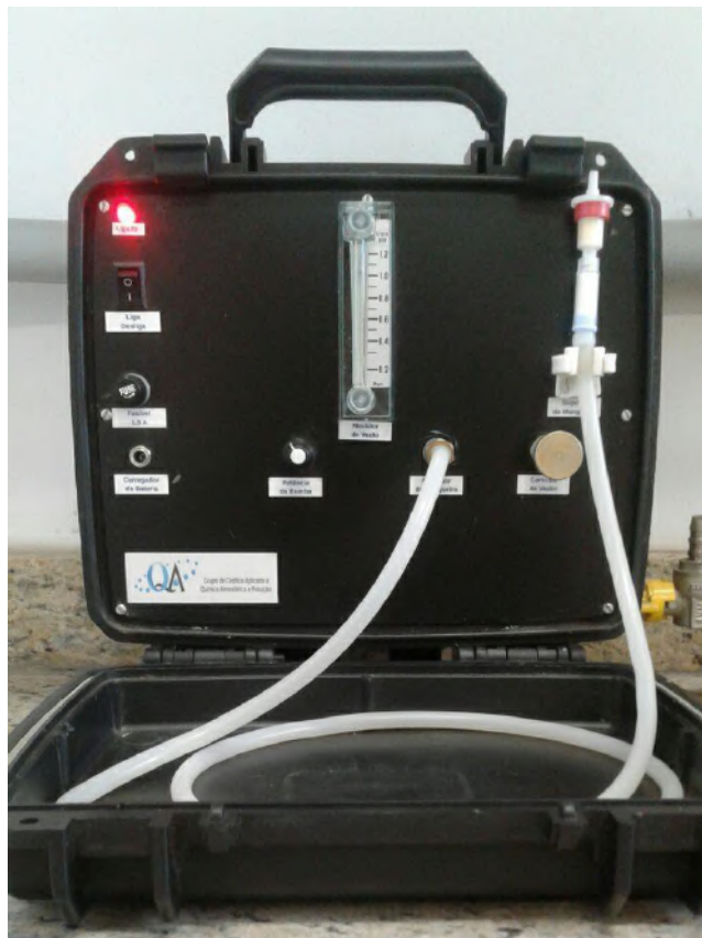
Figura 10: Bomba de amostragem de baixo volume. Fonte: o autor
