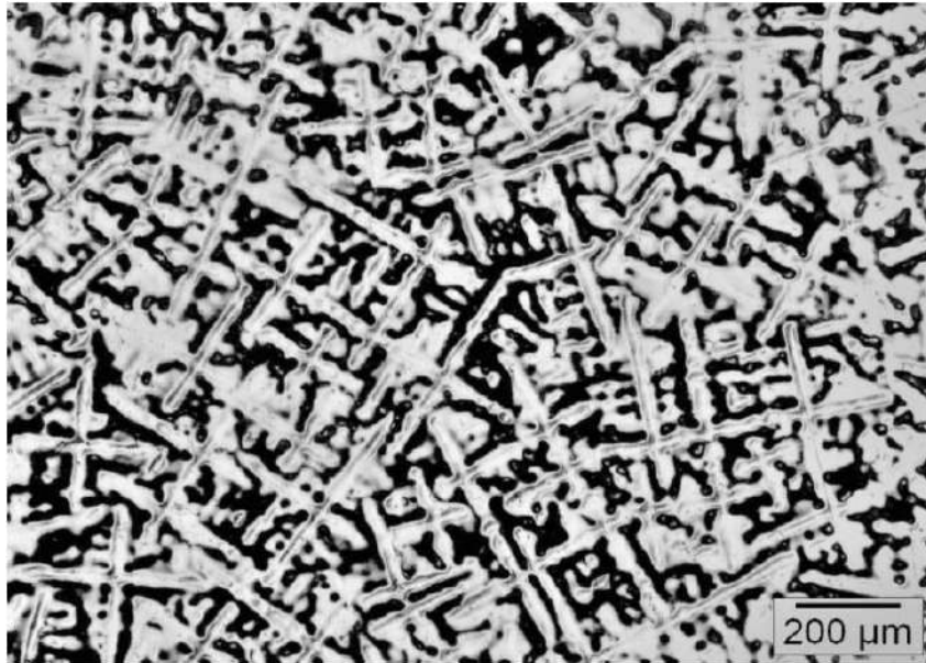
Figura 2.19: Microestrutura transversal do lingote. Parte Clara: dendritas. Adaptado de (ARAUJO, 2012).
