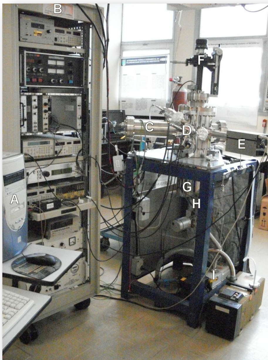
Figura 3: Sistema experimental montado no LaQuiS. A – PC com software de aquisição dos espectros; B – Rack com equipamentos eletrônicos para monitoramento e controle; C – Espectrômetro do tipo Tempo-de-Voo; D – canhão de elétrons; E – espectrômetro do tipo Quadrupolar; F – Manipulador de amostras; G – Bomba Sublimadora de Titânio; H – Bomba Turbomolecular; I – Bomba mecânica.
