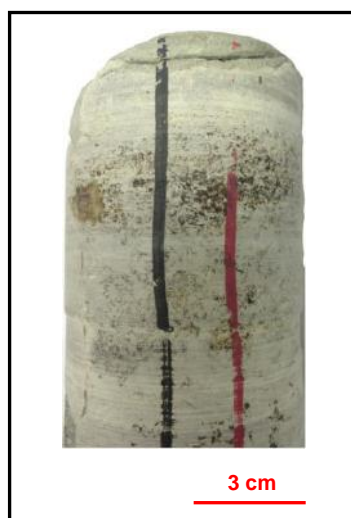
Figura 31 – Exemplo de amostra de testemunho (134,3 m de profundidade) com óleo residual confinado sob argilito e dentro de porosidade, provavelmente o topo dessa essa camada poderia armazenar óleo horizontalmente. Há também a presença de uma fratura na lateral esquerda do testemunho, o que cria a hipótese de que esse óleo pode ter migrado por estruturas como esta.
