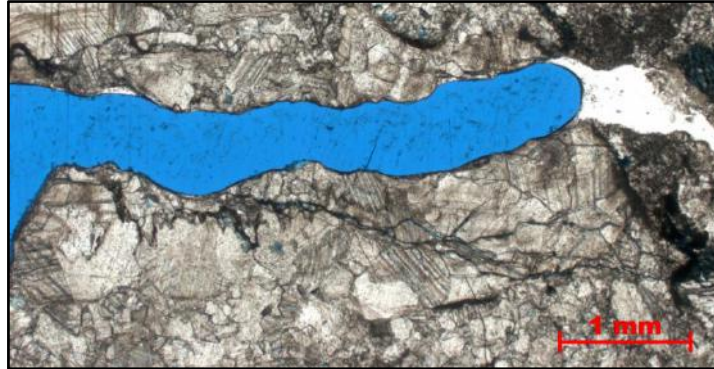
Figura 24 – Estilolito horizontal próximo à fratura (em azul) em lâmina delgada (nicóis cruzados, aumento de 1,25x), que nada ou pouco contribui para a condução de fluidos, seja pelo seu tamanho microscópico, seja por estar preenchido de material insolúvel.
