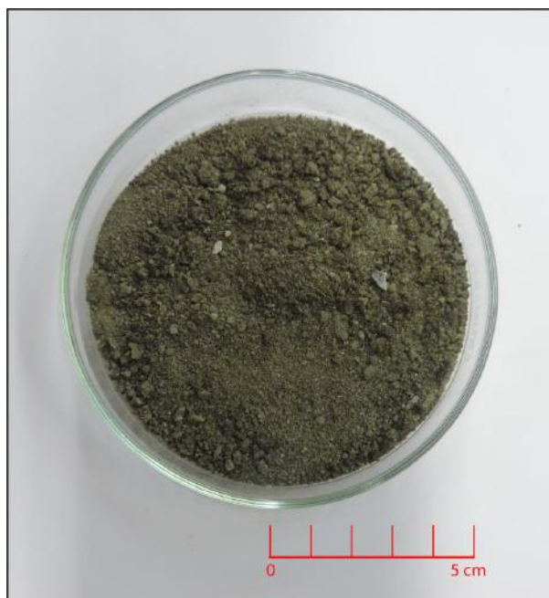
Figura 13 – Fácies A3. Areias de cor cinza esverdeado com fragmentos de conchas. Os grãos são médios, subangulosos, mal selecionados e compostos essencialmente por quartzo.
