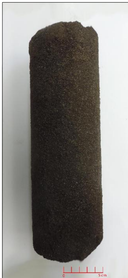
Figura 12 – Fácies A2 - arenito friável com alta concentração de matéria orgânica. Note aspecto atribuído a cimentação incipiente por matéria orgânica e hidróxido de ferro.
