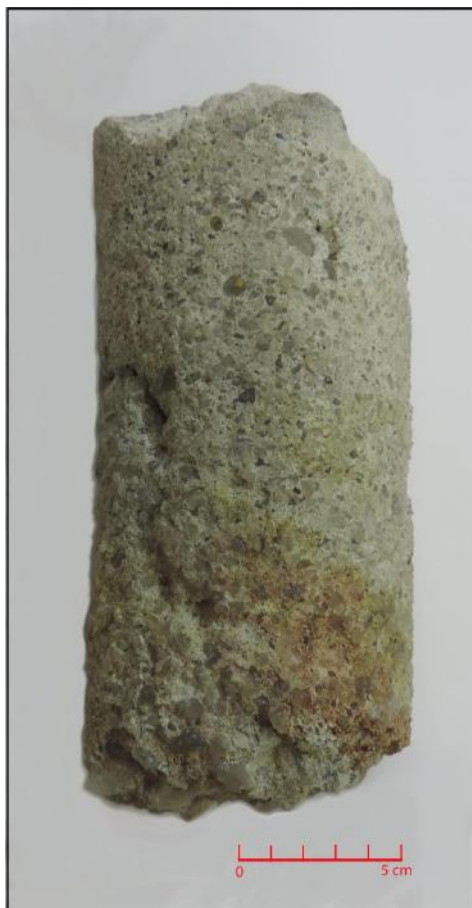
Figura 15 - Fácies C1. Ocorre na parte basal do testemunho, entre 25,40 e 25,70m. Trata-se de um conglomerado fino de cor cinza com manchas de oxidação, muito mal selecionado, grãos subangulosos a subarredondados, de granulometria variando de fino a grosso com clastos de até 3 cm.
