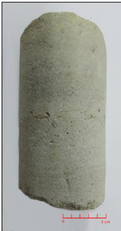
Figura 14 – Fácies AR1. Arenito médio de cor cinza com granulometria variando desde areia fina a areia grossa, subanguloso e muito mal selecionado. Apresenta-se alta litificação por sílica microcristalina.
