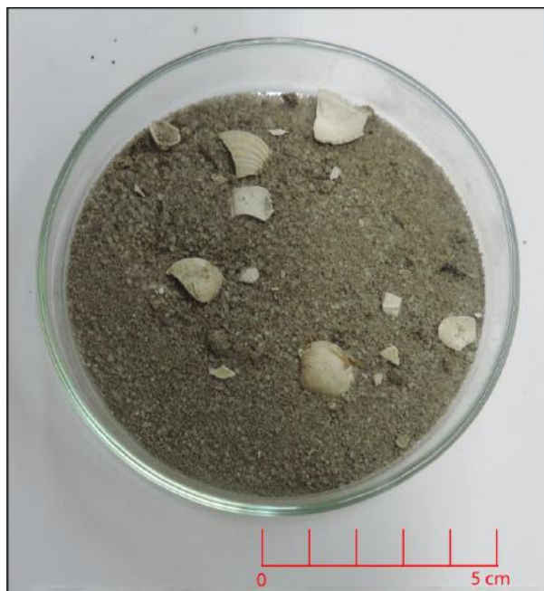
Figura 10 – Fácies A1. Areias médias a grossas de cor cinza, ricas em fragmentos de conchas, com grãos bem arredondados a subarredondados e compostos essencialmente por quartzo.
