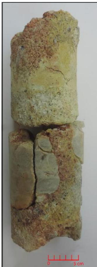
Figura 16 – Fácies C2. Conglomerado grosso de cor cinza, sustentado pela matriz areno-lamosa, maciço, composto essencialmente por grãos subangulosos de quartzo e subordinadamente apresenta placas esparsas de muscovita. Apresenta grãos de quartzo variando de fino a média na matriz e clastos variando de 2 a 7 cm.
