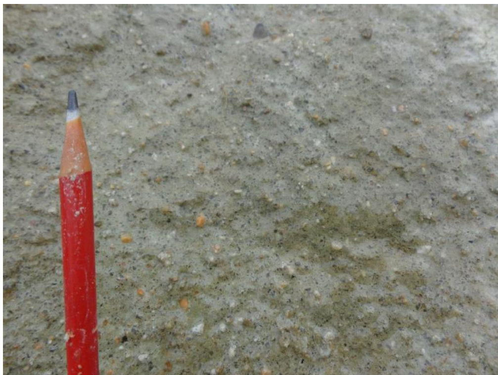
Figura 25: Rodovia SP-65 (ponto 6) - lamito arenoso maciço com grânulos de quartzo e feldspato. Litofácies ALm.
