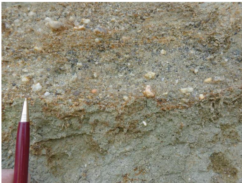
Figura 19: Rodovia SP-65 (ponto 7) - litofácies Cch(i) em contato com lamitos (litofácies Lm). Nesta imagem é possível identificar percolação de óxidos e/ou hidróxidos de ferro.
